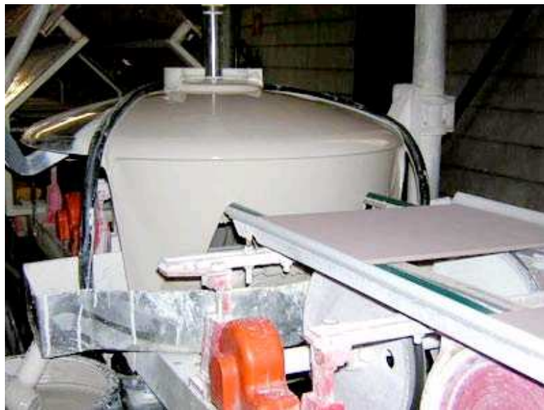
Figura 18 – Aplicação de esmalte (véu campana) (KINGERY, 1998).
