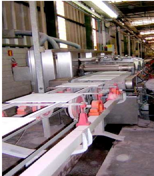
Figura 17 – Linha de esmaltação (BRISTOT, 1996).
