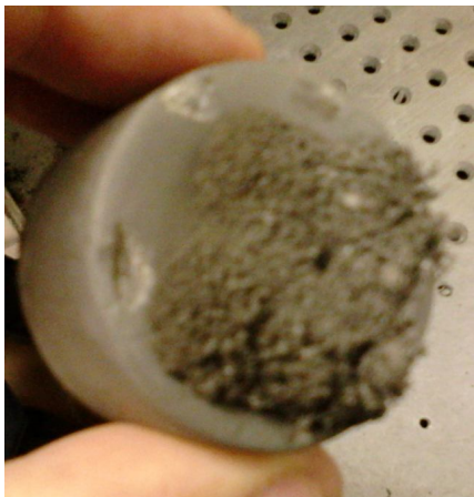
Figura 3. 10 Retirada de ferro metálico.
