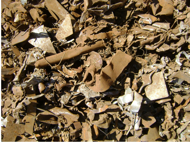
Figura 4. 2 Sucata Shredder de qualidade intermediária.
