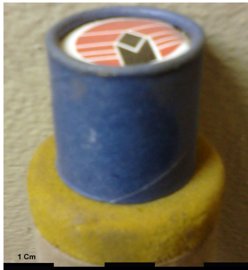
Figura 3.6 Extremidade do cartucho para retirada de amostra de aço.
