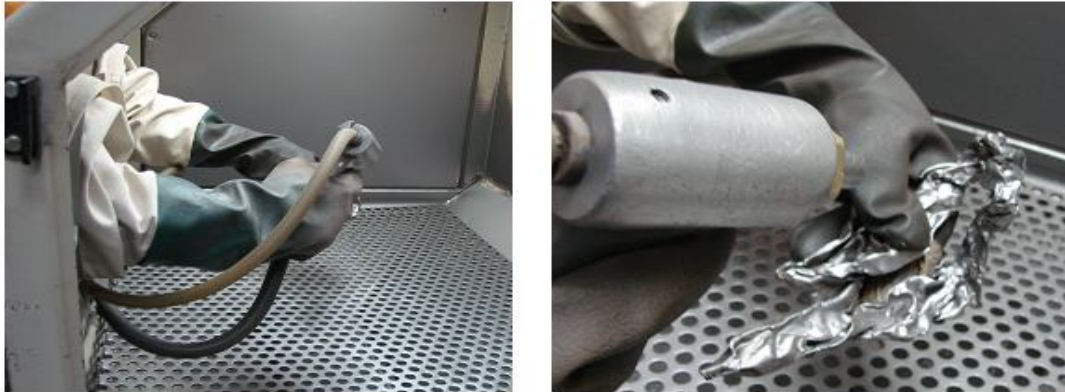
Figura 3.5 Jateamento com esferas de vidro.
