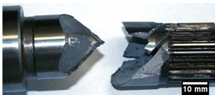
Figura 1.1 Fratura na região da haste da tulipa utilizada no projeto. Fonte: Imagem de documento interno da GKN Driveline.
