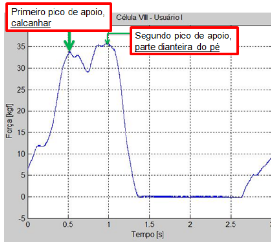
Figura 4.28 – Gráfico ampliado da célula oito para usuário I, em destaque os picos de força.
