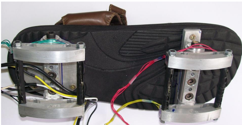
Figura 4.7 – Vista dos subconjuntos da plataforma de força fixados por meio de parafusos Allen M6 às placas de apoio.
