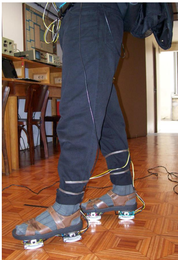
Figura 4.20 – Utilização da plataforma de força pelo usuário I.
