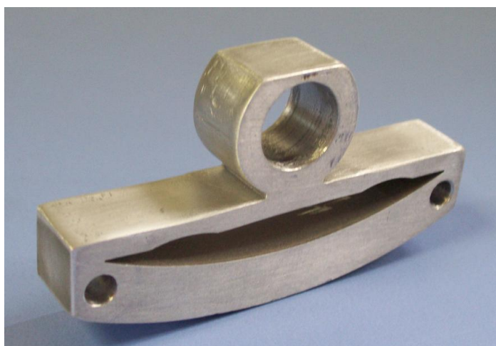
Figura 4.4 – Vista lateral da célula de carga fabricada.
