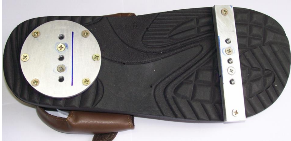
Figura 4.5 – Placas de apoio fixadas na sola do calçado por meio de parafusos.
