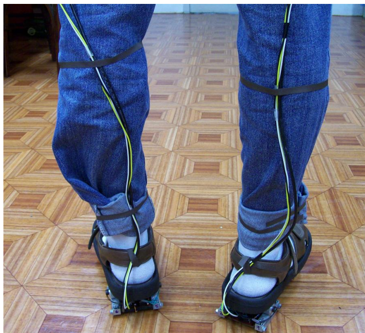
Figura 4.22 – Vista da parte de trás da plataforma de força quando utilizada pelo usuário II.
