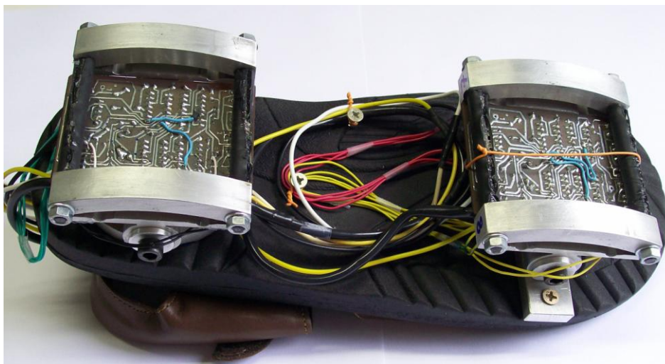
Figura 4.8 – Vista completa da plataforma de força de pequeno porte para solado com as placas dos condicionadores de sinais montadas nos dois subconjuntos.
