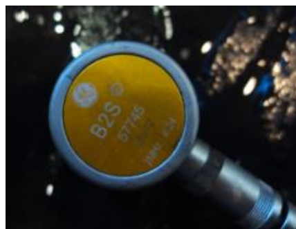
Figura 3.3: Cabeçote utilizado no ensaio de ultra-som sobre a peça com acoplante.
