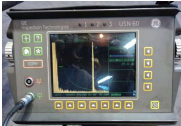
Figura 3.4: Aparelho marca GE, modelo USN 60 utilizado na inspeção das duas chapas.
