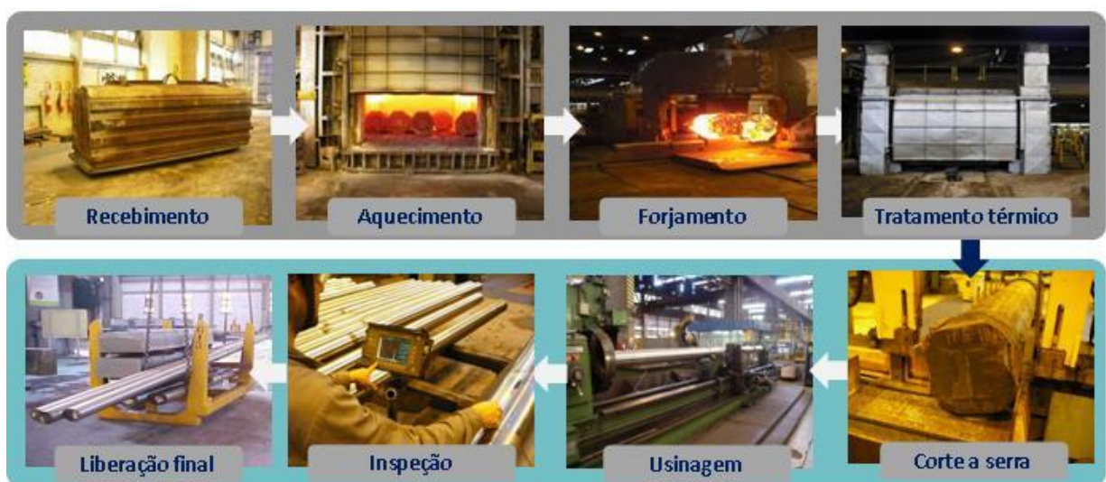
Figura 1.1. Fluxo de produção de barras forjadas na forjaria. (Fonte: Usina Piratini, 2010).
