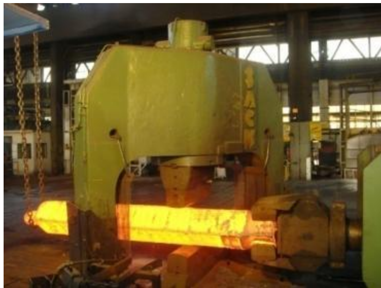
Figura 2.4. Prensa de mil toneladas executando forjamento em matriz aberta de barra redonda (Usina Piratini – 2006)
