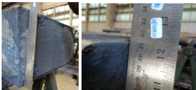
Figura 3.1: Espessura das chapas utilizadas nos experimentos.
