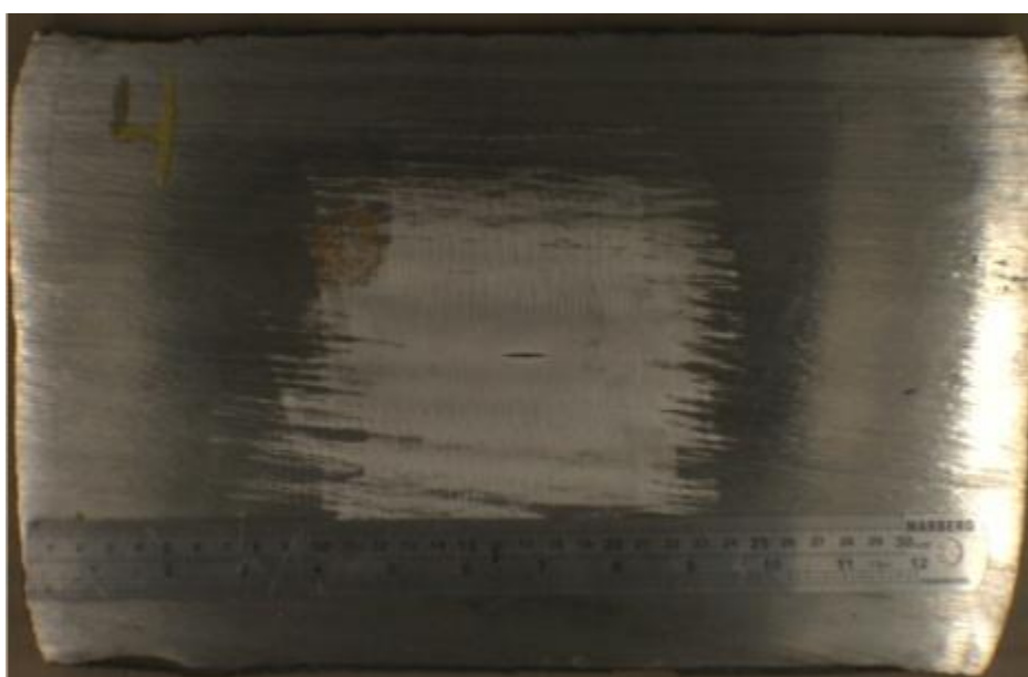
Figura 4.5: Amostra 4 com a região do furo rebarbado.
