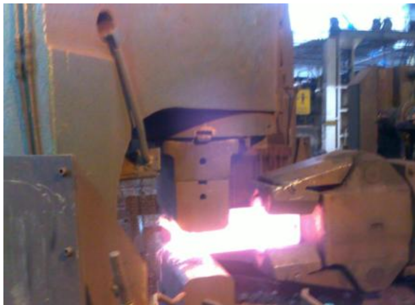
Figura 3.15: Forjamento da amostra 4 – configuração AA e tempo de encharque de 7 horas.
