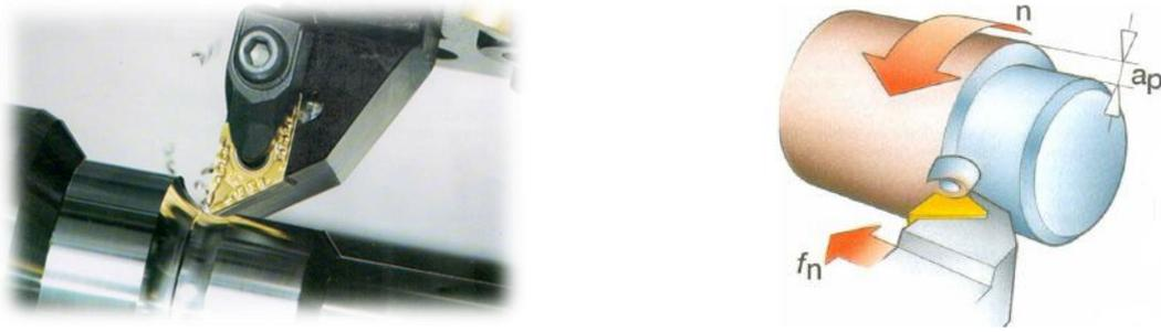
Figura 3.1 – Torneamento cilíndrico externo [Sandvik, 2012].
