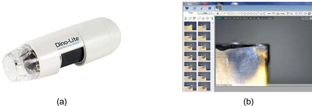
Figura 4.5 – (a) Microscópio Dino-Lite modelo AM-413ZT; (b) interface do software dedicado para aquisição das imagens.
