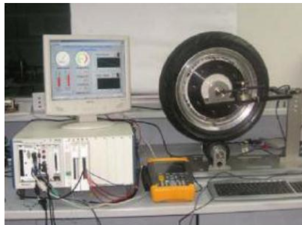
Figura 3.4 - Bancada utilizada para testar motores elétricos em carros híbridos [Rahim et al, 2006 apud Silva 2011].
