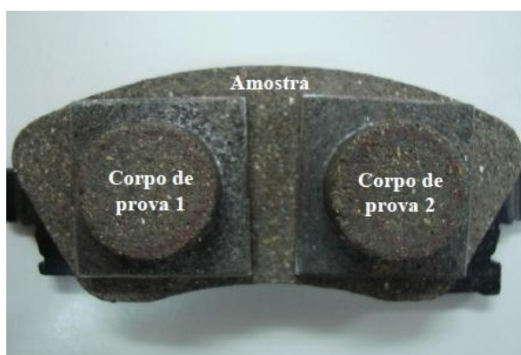
Figura 4.1 – Pastilha de freio comercial e os corpos de prova.
