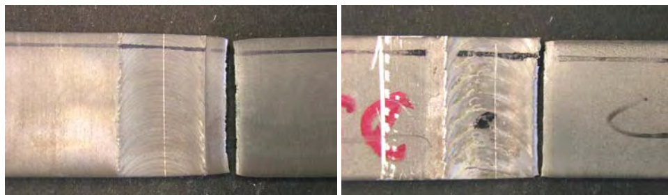
Figura 4.29 Posição de ruptura nas juntas da liga 6181 T4 soldadas com velocidades de 1 m/min (esquerda) e 10 m/min (direita).
