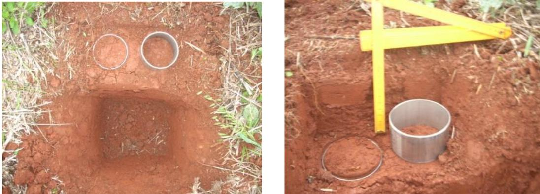
**Figura 5.** Mini-trincheiras e coleta de amostras indeformadas de solo.
