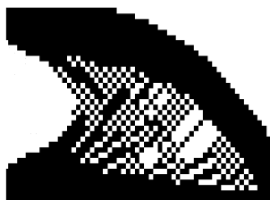
Figura 5.2: Topologia com instabilidade de tabuleiro.
