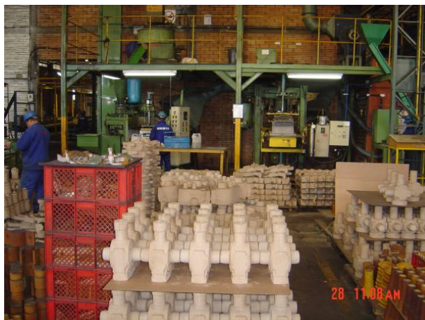
Figura 16: Preparação dos machos.
