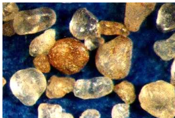
Figura 07: Areia da Figura 6 regenerada por calcinação. Fonte: Mariotto (2000b).
