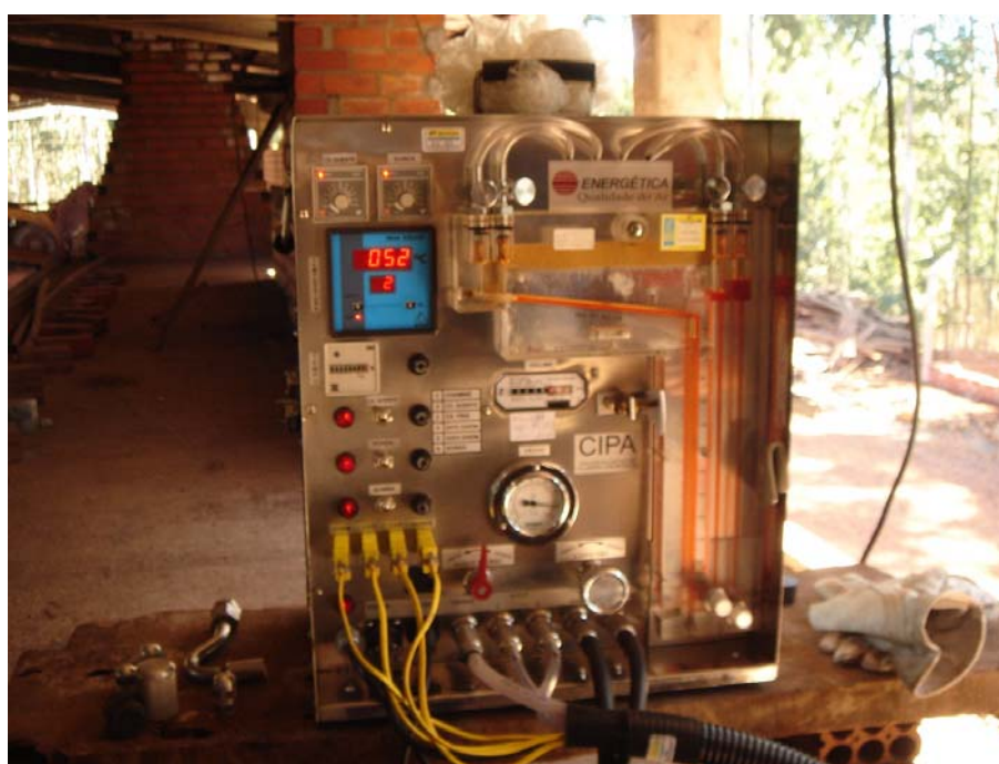
Figura 27: Caixa de controle de amostragem isocinética de gases e material particulado composta de gabinete; medidor de temperatura; manômetro de 02 colunas, com parte inclinada, escala total de 0 a 25 mmH 2 O; gasômetro com vazão máxima de 3 m 3 /h, leitura de 0 a 0,999 m 3 , leitura mínima de 0,21; vacuômetro; variador de potência; totalizador de tempo (horômetro); válvulas de controle de bomba; variador de potência; leitor de temperatura digital de 06 canais, calibrado para termopar de tipo K Chromel-Alumel.
