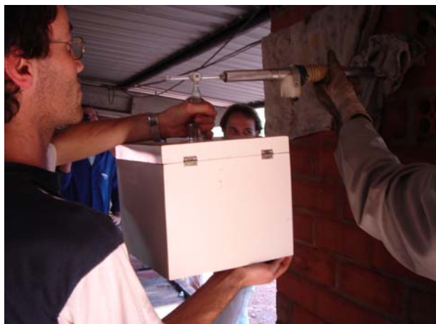
Figura 29: Medição de NO x .
