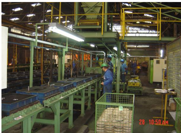
Figura 15: Preparação dos moldes em areia verde.
