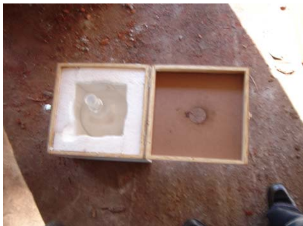
Figura 30: Vista interna da caixa de medição de NO x .
