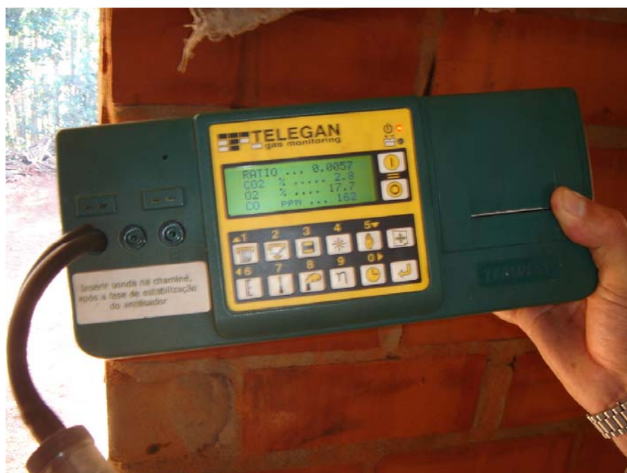
Figura 31: Aparelhagem para a determinação dos gases de combustão, da CONFOR modelo TEMPEST 50.
