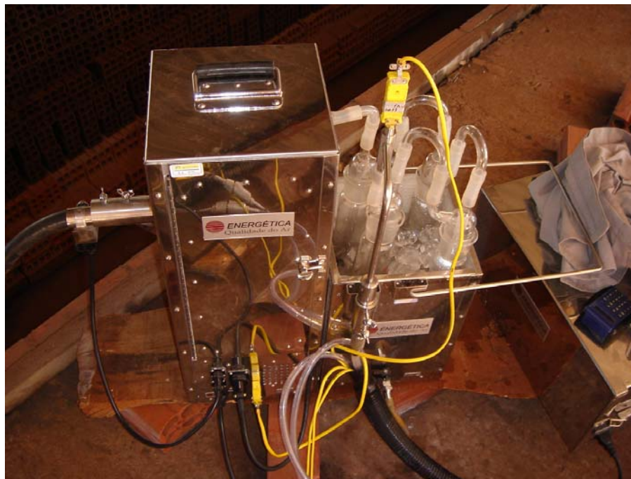
Figura 28: Caixa quente e caixa fria (borbulhadores em banho de gelo) e caixa bomba – parte da aparelhagem de amostragem isocinética de gases e material particulado.
