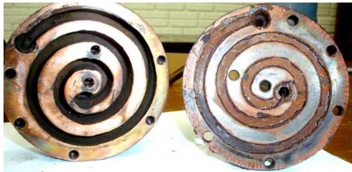
Figura 4.20: Detalhe interna da base de cobre utilizada nos experimentos.
