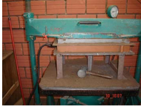
Figura 4.8: Compactação do molde.
