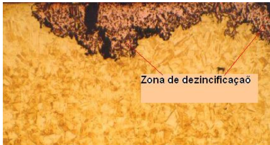
Figura 3. 9: Dezincificação do latão almirantado [Seungman 2005].
