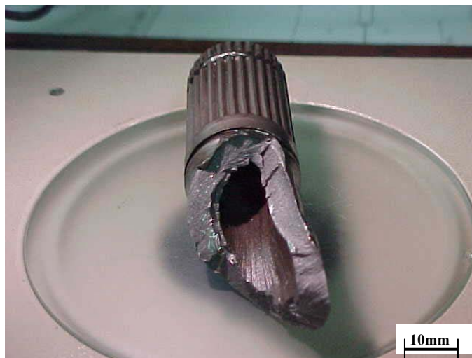
Figura 4.19 A falha ocorre na parte externa da peça junto ao diâmetro menor do junta fixa. A fratura se propagou a 45° formando uma “orelha de lobo”. A ruptura foi devido a aplicação de tensão acima do especificado. O valor de ruptura desta peça foi de aproximadamente 2800Nm. A peça acima é do lote da amostra B.
