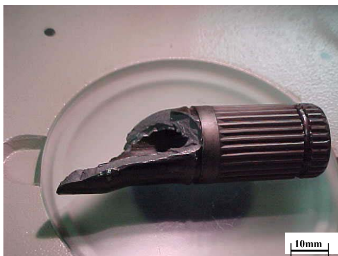
Figura 4.20 A falha ocorre na parte externa da peça junto ao diâmetro menor do junta fixa. A fratura se propagou a 45° formando uma “orelha de lobo”. A ruptura foi devido a aplicação de tensão acima do especificado. O valor de ruptura desta peça foi de aproximadamente 2800Nm. A peça acima é do lote da amostra B.
