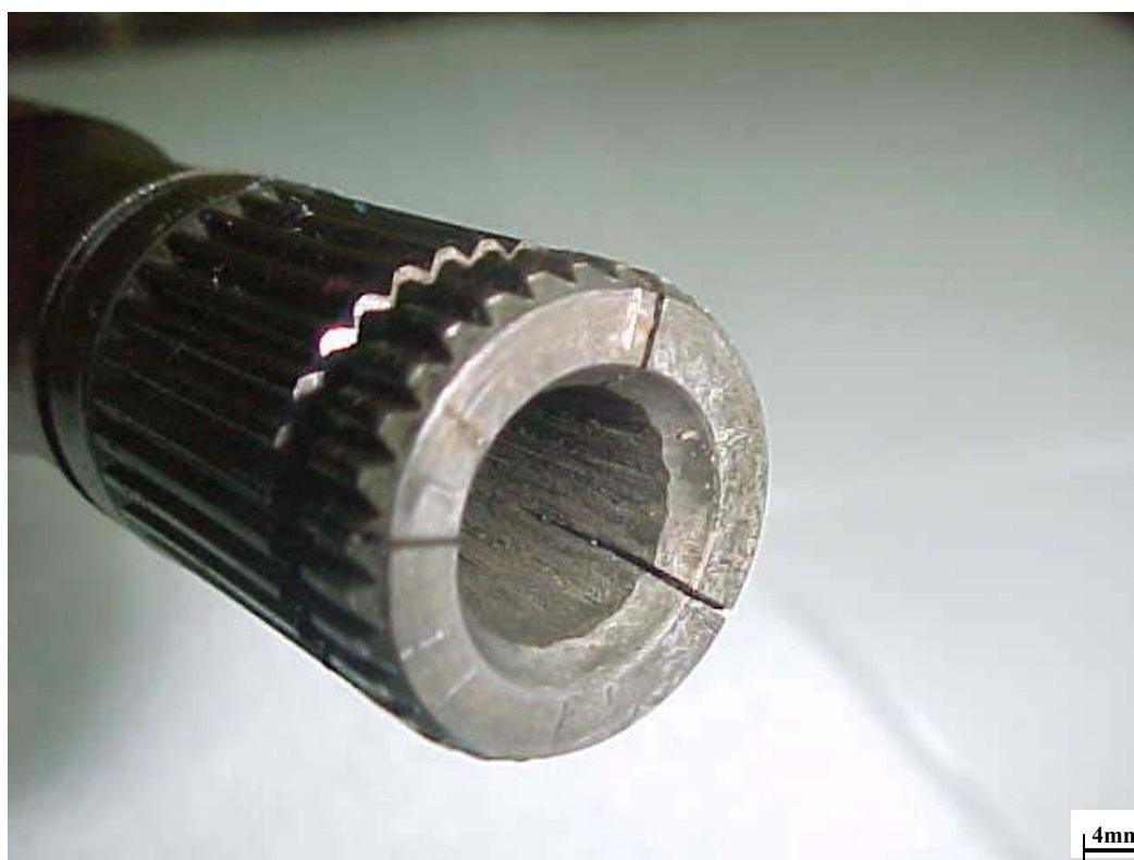
Figura 4.10 Eixo monobloco tubular fabricado com mesmo lote de matéria prima da Amostra C apresentou trinca de topo após conformação do entalhado.
