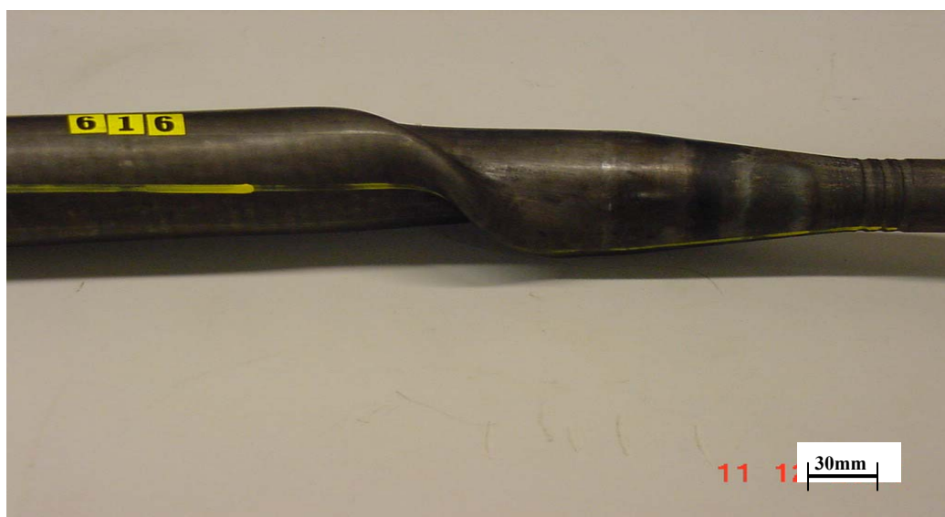
Figura 6.1 Eixo monobloco tubular com problema de “Twist” no teste de torção estática. Este problema ocorre uma vez que o eixo é somente temperado por indução nas extremidades e por isto a região central apresenta menor resistência. (GKN Alemanha)
