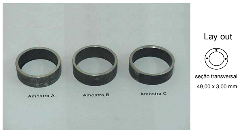
Figura 3.4 Corpos de prova preparados para ensaio de dureza Vickers (HV10).
