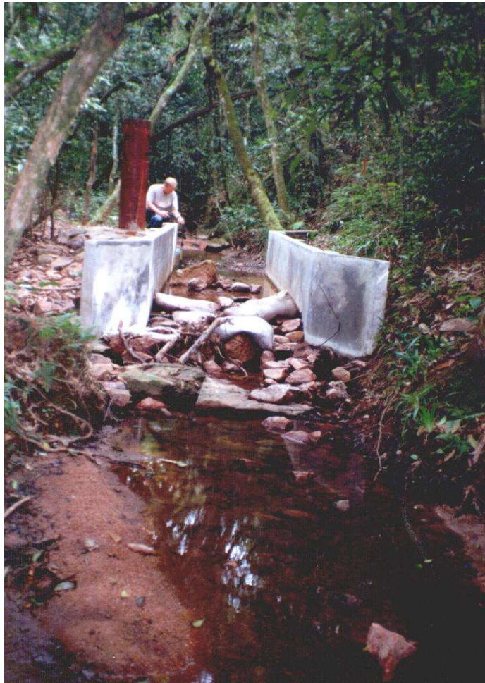
Figura 4.7 – Canal de Medição da Vazão no Ponto Amostral CO1 (Arroio Condor)
