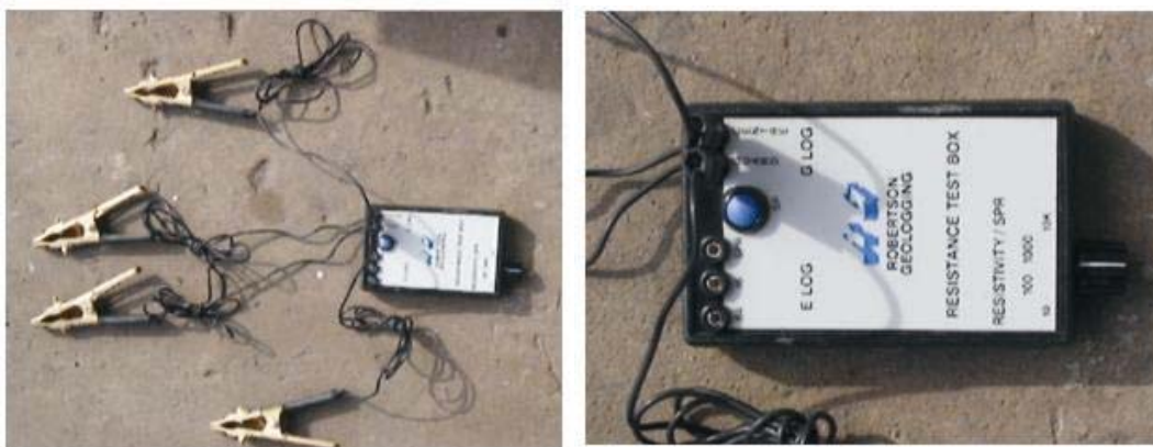
Figura 2.22 - Caixa com valores de resistividade padrão para a calibração
