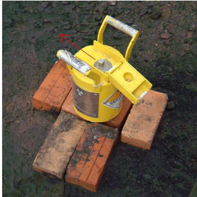
Figura C.4 - Foto da embalagem com indicação da direção de colimação da fonte radioativa.
