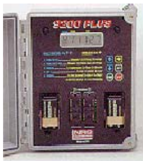
Figura 41: Data logger da estação de medição
