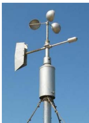
Figura 35: modelo de um anemômetro de conchas (INSTITUT FÜR SOLARE ENERGIEVERSORGUNGSTECHNIK, 2004)
