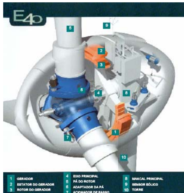
Figura 25: turbina eólica E-40 da ENERCON (WOBBEN, 2004)
