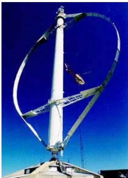
Figura 01: TEEV- modelo Eole, 4.MW, 100 m altura, Cap-Chat, Quebec-Canadá (DARRIEUS WINDTURBINE-ANALYSIS, 2005)
