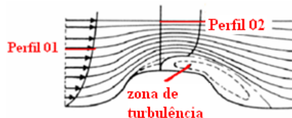
Figura 31: aceleração do vento sobre colinas e inclinações (INSTITUT FÜR SOLARE ENERGIEVERSORGUNGSTECHNIK, 2004)
