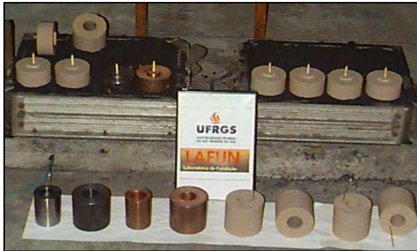
Figura 13: Coquilhas Metálicas e Moldes de Areia utilizados nos experimentos. Sendo, num primeiro plano, da esquerda para a direita: molde fino de aço, molde grosso de aço, molde fino de cobre, molde grosso de cobre e quatro moldes grossos de areia. Num segundo plano, da esquerda para a direita: duas bases de areia, base de aço, base de cobre e quatro bases de areia.
