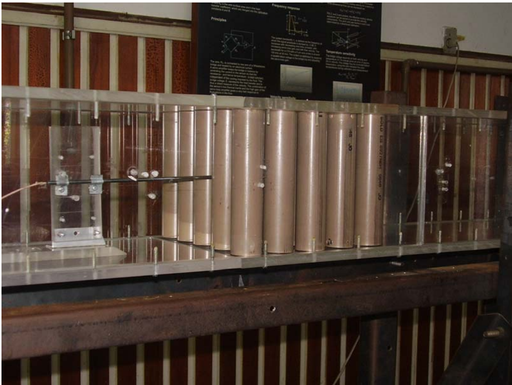
Figura 3.6 - Banco de tubos posicionado no interior do túnel. Na foto, o escoamento ocorre da direita para a esquerda.
