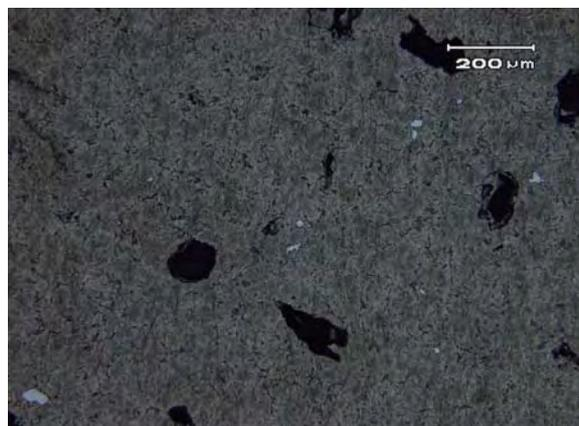
Figura 90. a) O gráfico mostra como este tratamento foi realizado. b) Micrografia da estrutura gerada por AM a 625°C durante 30 minutos, resfriado em temperatura ambiente por três minutos até a temperatura de 480°C e após resfriado em água. 100X Ataque Keller.
