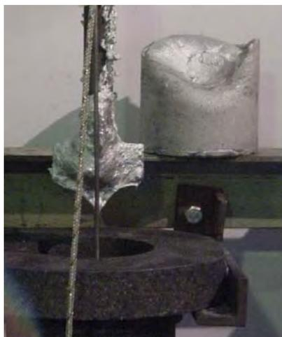
Figura 70. Tarugo produzido por agitação mecânica após solidificação e de ser retirado do cadinho.
