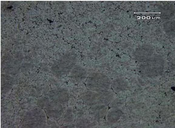
Figura 81. Micrografia da estrutura gerada por agitação mecânica a 625°C durante 15 minutos, resfriado em água. Ataque Keller, 100X.
