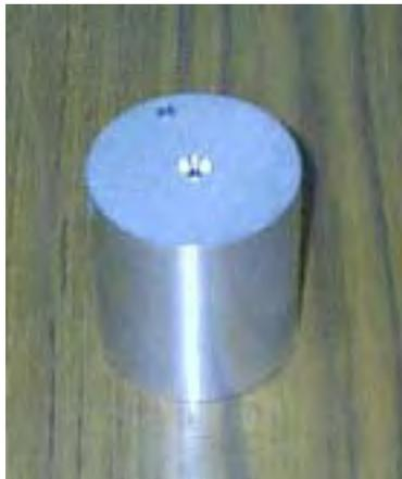
Figura 71. Tarugo usinado de  $\phi 60\text{mm}$  e 60mm de altura, com dois furos para o posicionamento dos termopares.
