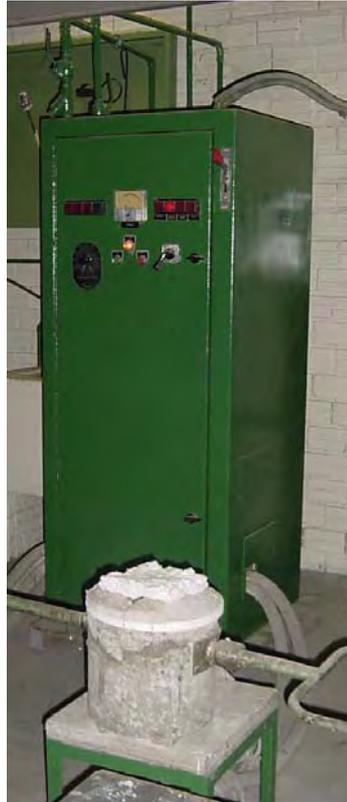
Figura 73. Unidade de geração e forno indutivo Inductotherm – 20kW do LAFUN, utilizado nos experimentos.
