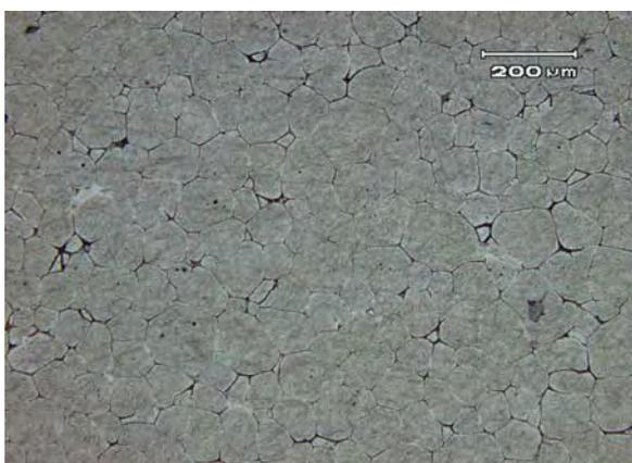
Figura 99. Micrografia da liga 7075 REA 600°C, 20min.
