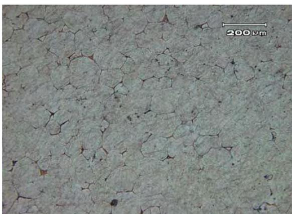
Figura 97. Micrografia da liga 7075 REA 590°C, 30min.
