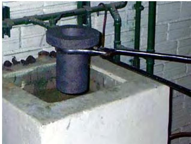
Figura 61. Retirada do cadinho com a liga no estado pastoso e resfriamento em tanque com água a temperatura ambiente.
