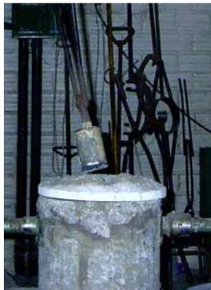
Figura 77. Detalhe da pinça para a extração do tarugo do forno.
