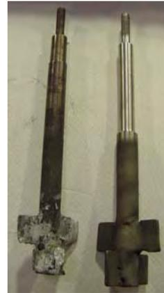
Figura 64. Detalhes do desgaste das pás. Pás antes e após três agitações (uma hora de trabalho).
