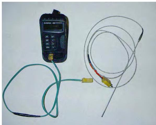
Figura 68. Termopar tipo K, com bainha de aço e cabo de compensação e o sensor de temperatura utilizado.
