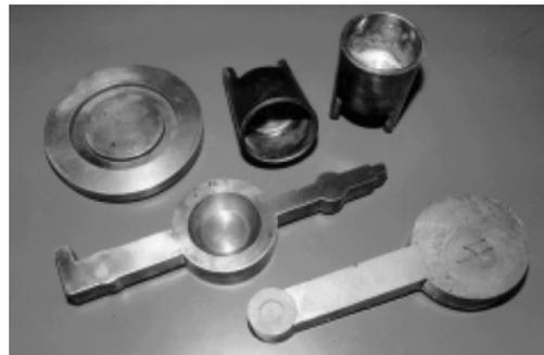
Figura 17. Várias peças tixoforjadas de alumínio. [Kopp; 2001]
