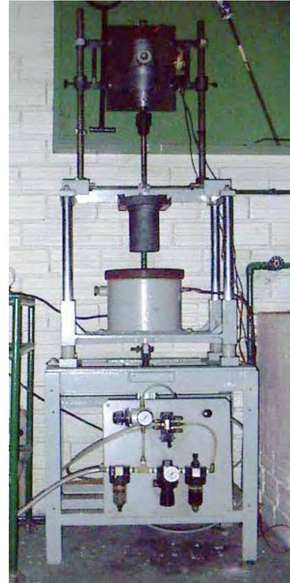
Figura 59. Conjunto da máquina usada no processo de agitação mecânica e levantamento do forno.
