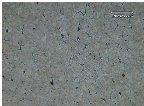
Figura 98. Micrografia da liga 7075 REA 600°C, 10min.
