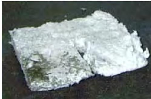
Figura 69. Manta refratária de lã de rocha para o isolamento térmico do cadinho.
