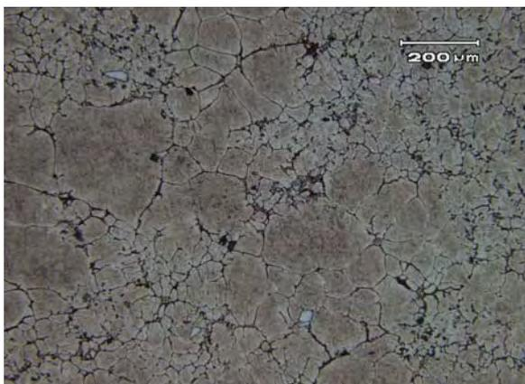
Figura 85. Micrografia da estrutura gerada por AM a 625°C durante 30 minutos, resfriado em água. 100X Ataque Keller.
