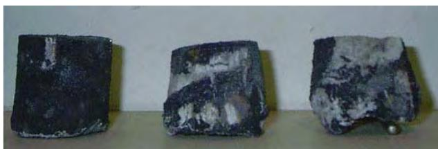
Figura 108. Corpos de prova, reaquecidos a três frações de sólidos diferentes, seja a 590, 600 e 605°C, mostrando as deformações do mesmo.
