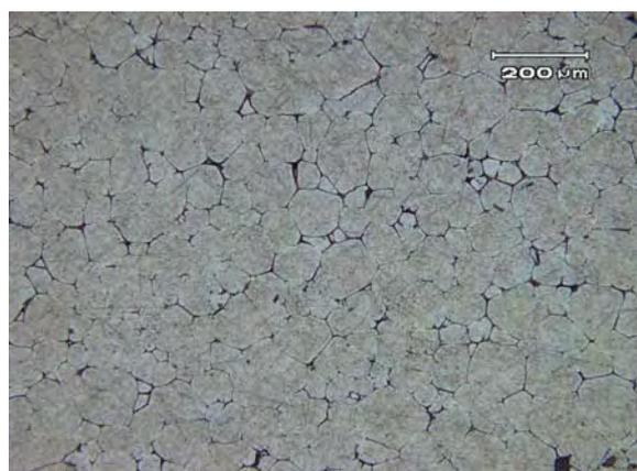
Figura 96. Micrografia da liga 7075 reaquecida a 590°C por 20 minutos. 100X Ataque Keller.
