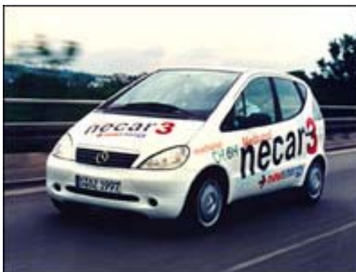
Figura 4.1 - Nekar, protótipo da Daimler-Chrysler movido à célula de combustível.
