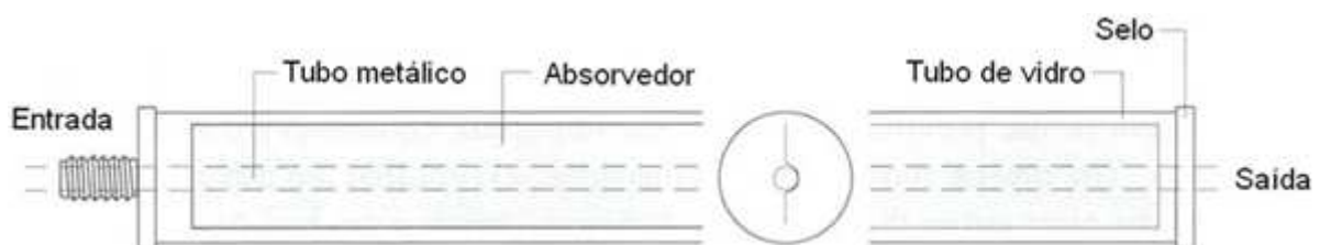
Figura 2.5 – Modelos de coletores de tubos de vidro evacuado. Fonte: Duffie e Beckman, 1991.
