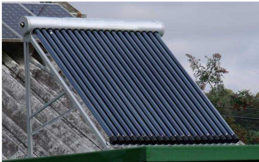
Figura 5.5 – Coletor de tubos evacuados ensaiado.
