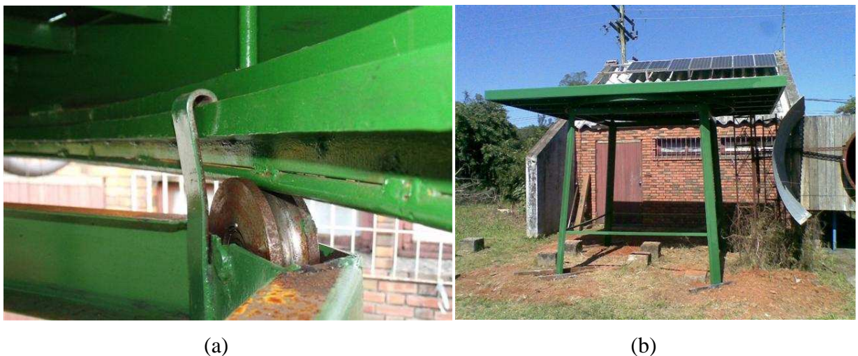
Figura 4.2 – Bancada de ensaios: (a) Sistema de segurança do trilho e rodas. (b) Foto da bancada construída.
