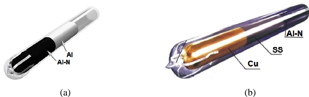
Figura 2.8 – Camadas seletivas: (a) Camada de Al-N/SS/Cu; (b) Camada de Al-N/Al.
