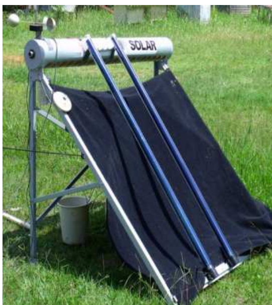
Figura 5.4 – Foto da bancada para avaliação das propriedades ópticas dos tubos.
