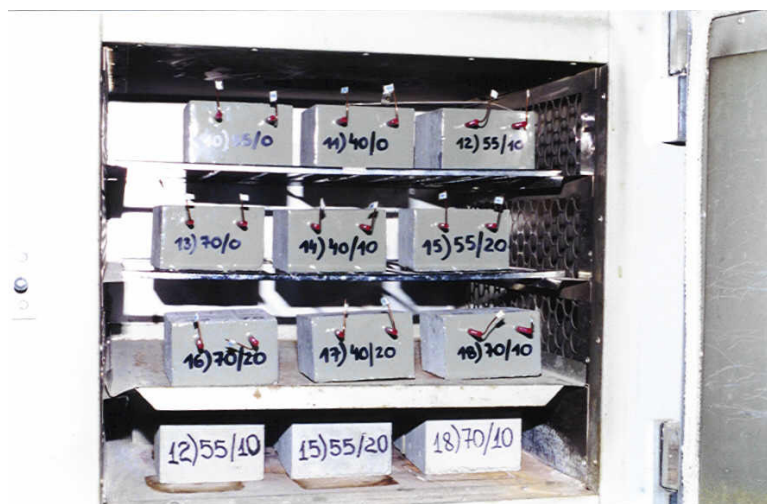
Figura 4.8 Secagem dos corpos-de-prova em estufa a 50° C.
