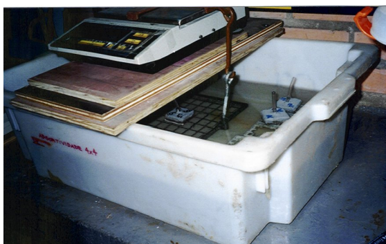
Figura 4.13 Dispositivo utilizado para a execução do ensaio de absorção de água (KULAKOWSKI, 2002).
