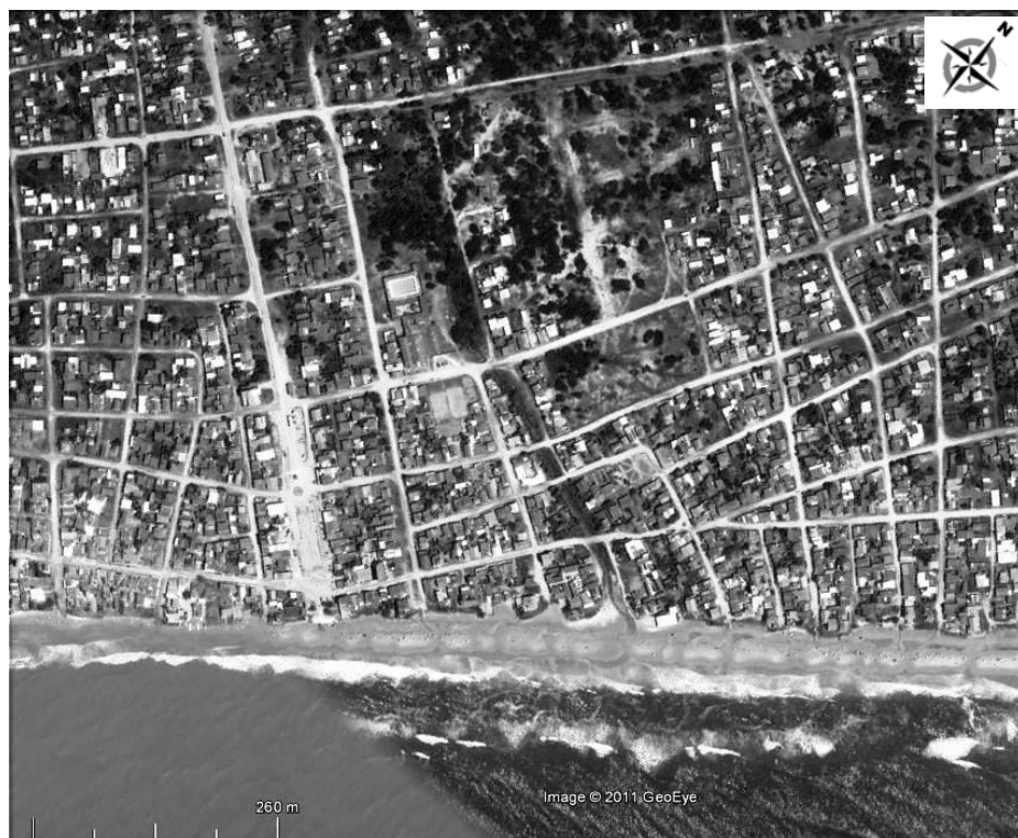
FIGURA Nº 5 - Porção do litoral em acentuado processo de erosão, sem presença do cordão de dunas. Praia do Hermenegildo, Santa Vitória do Palmar, litoral sul. Fonte: Google Earth, 2011. Coordenada central: 33°39'49.80''S, 53°15'37.86''O.
