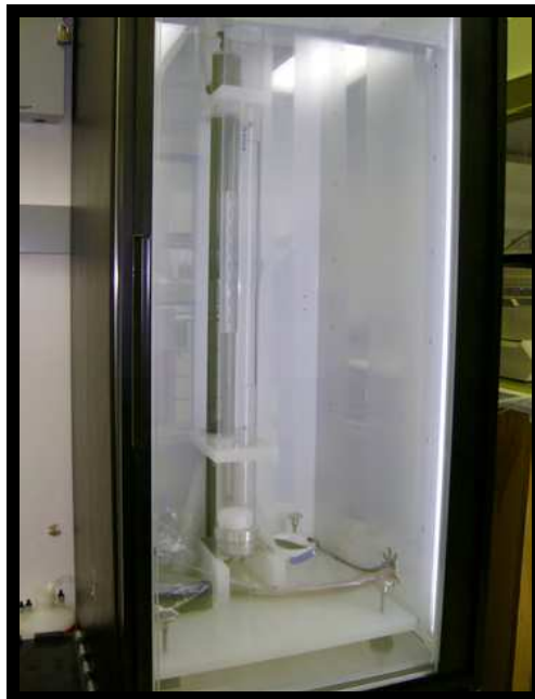
Figura 2.10 – Freezer (-20 °C) adaptado para o derretimento da seção que é acoplada ao sistema de derretimento da amostra.
