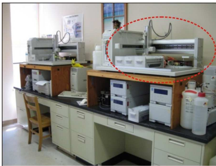
Figura 2.17 – Sistema de cromatografia iônica utilizados pelo laboratório do CCI, Universidade do Maine, composto por: 2 amostradores ( passers ), computador e dois cromatógrafos DIONEX Corporation, modelo DX-500. Em detalhe a introdução das amostras no sistema com a utilização do passer .
