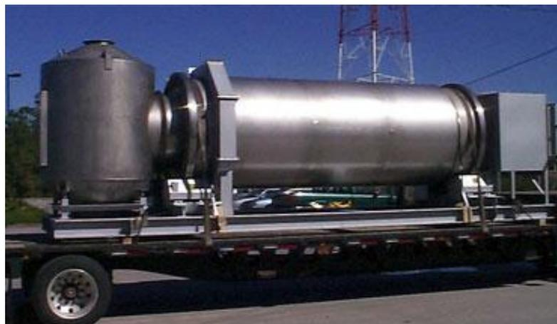
Figura 1 – Secador rotativo
