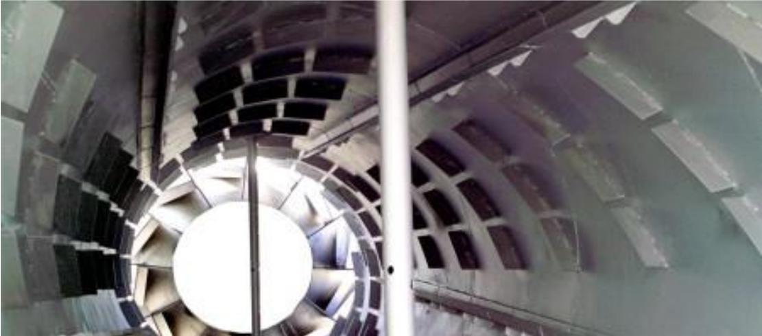
Figura 2 – Parte interna de um secador rotativo
