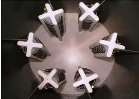
Figura 12 – Base com resistores elétricos
