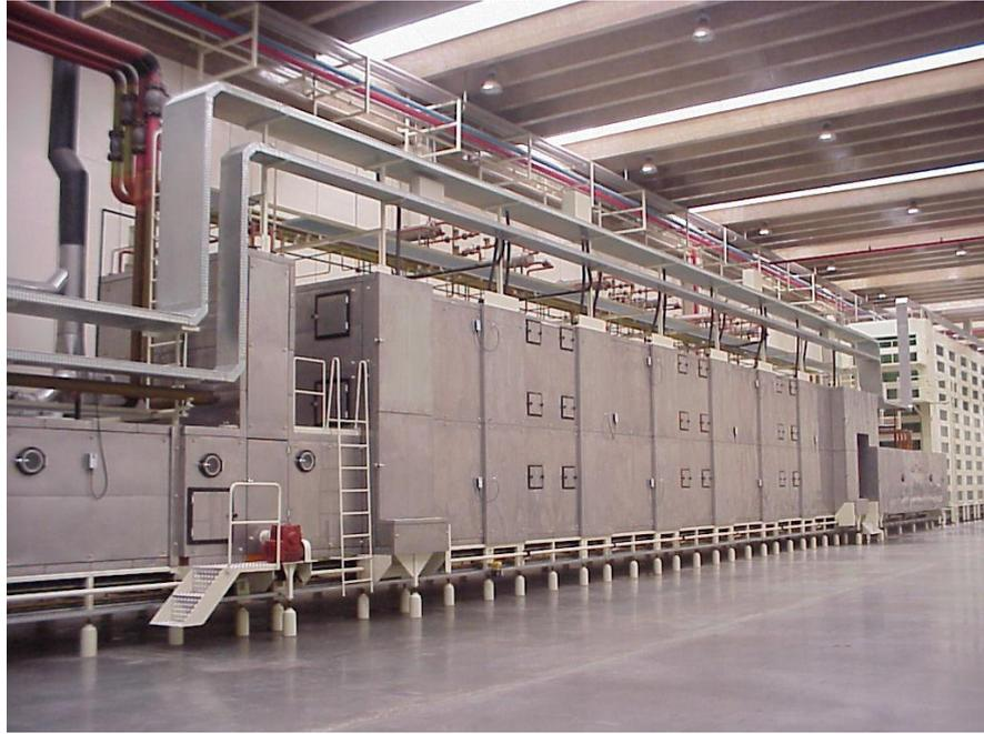
Figura 10 – Secador de túnel
