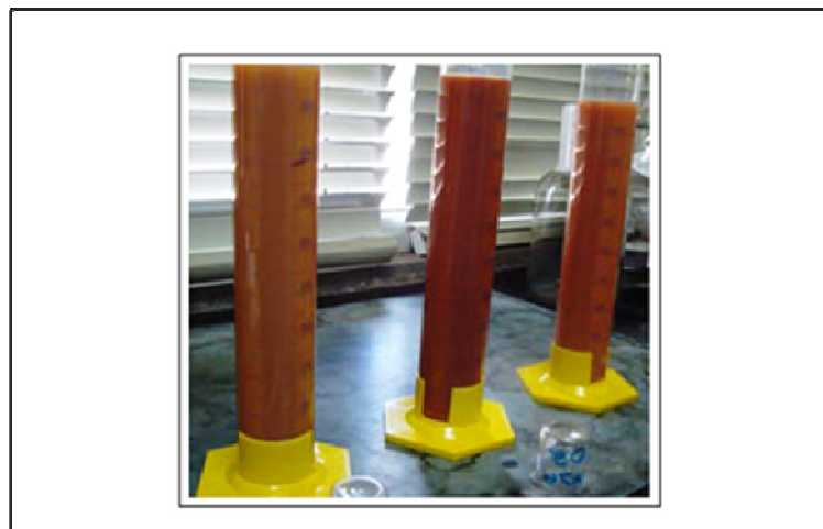
Figura 34 – Conjunto de Provetas para separação de materiais finos ( < 0,064 mm)
