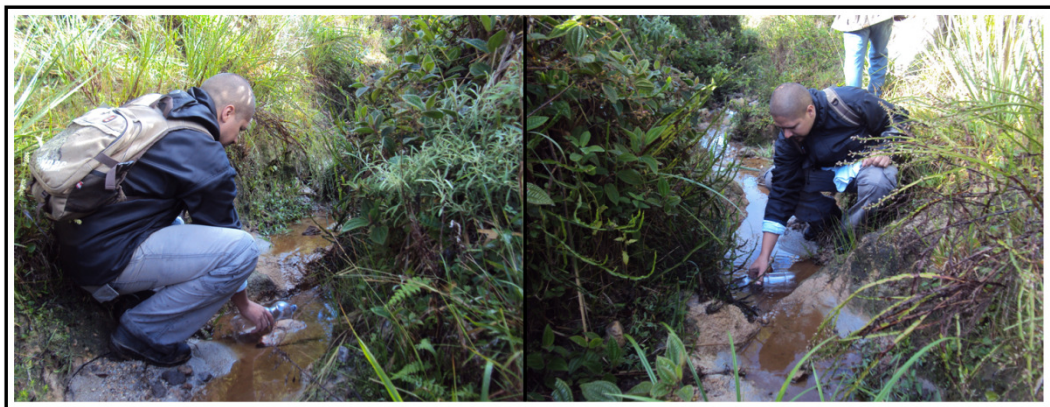
Figura 22 – AAFP-02: Coleta de água em ponto de descarga do lençol freático, contato regolito – rocha. No local também foi amostrado o regolito da área de recarga
