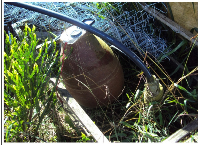
Figura 24 – AAFP-04: Coleta de água em poço tubular no meio fraturado, de duas polegadas para abastecimento doméstico.
