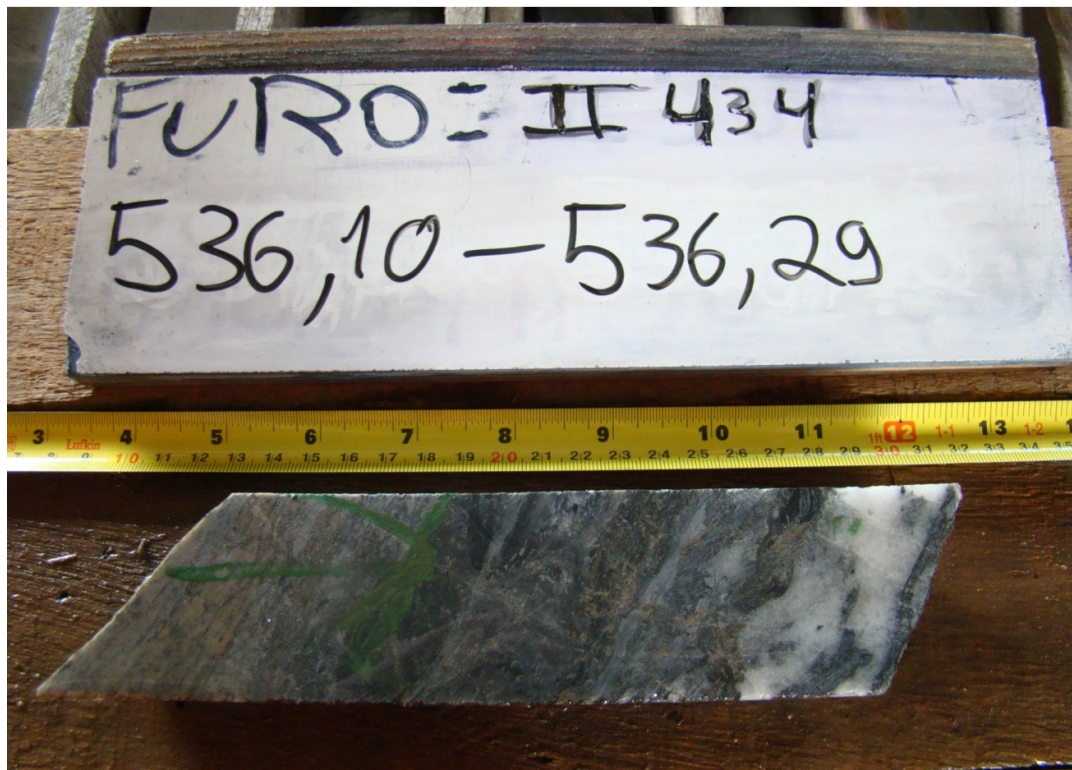
Figura 22: marca o fim da estrutura IV e da Zona de Silicificação.
