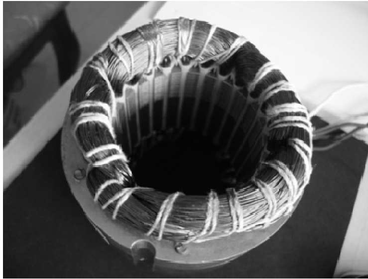
Figura 7.29 - Estator do motor em que foi realizado o experimento junto com o marcador
