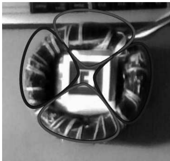
Figura 7.32 - Estator do motor junto com o campo girante – posição 1
