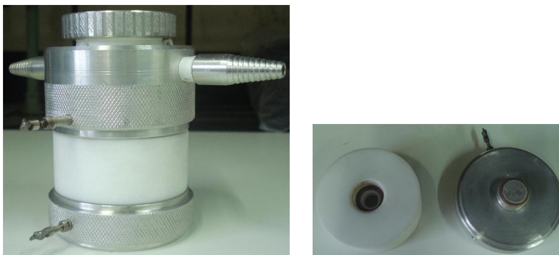
Figura 15. Foto da célula termogalvânica em forma de rosca (esquerda) e do cilindro de Teflon® e semicélula quente (direita).
