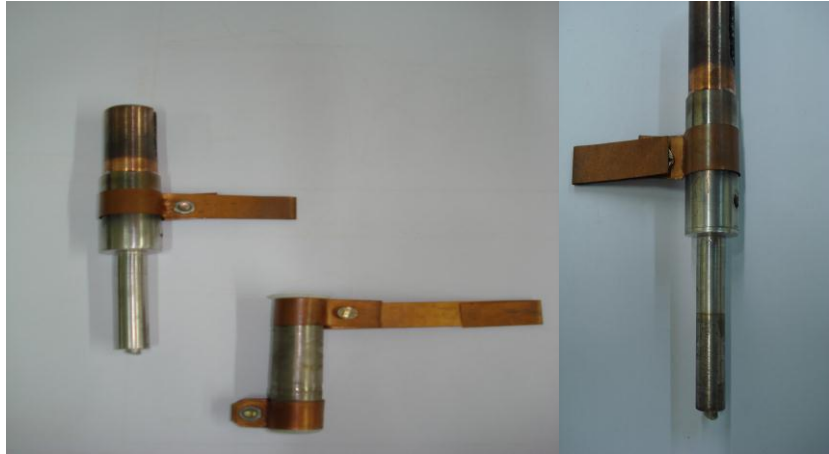
Figura 17. Foto da célula termogalvânica de cobre com eletrodeposição por sputtering de paládio (esquerda) e semicélula quente com desprendimento de paládio (direita).
