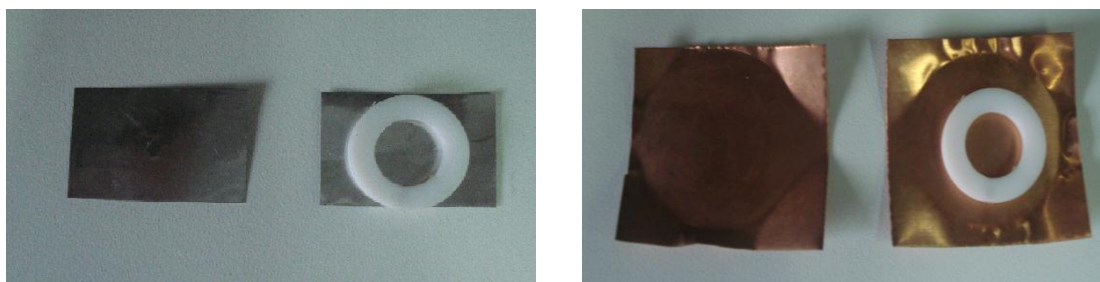
Figura 13. Foto das placas de platina (esquerda) e cobre (direita) empregados como eletrodos nas células termogalvânicas apresentadas na Figura 12.
