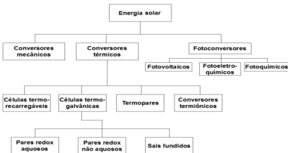
Figura 4. Fluxograma da classificação de vários sistemas que podem ser utilizados para converter energia solar em energia elétrica.
