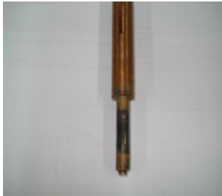
Figura 18. Foto da semicélula quente confeccionada de cobre com eletrodeposição de platina apresentando o desprendimento de platina 61 .
