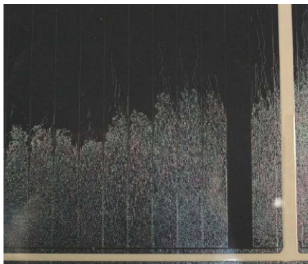
Figura 4.11 – Degradação da camada condutora transparente de módulos de silício amorfo em decorrência de polarização negativa [Osterwald et al., 2003].
