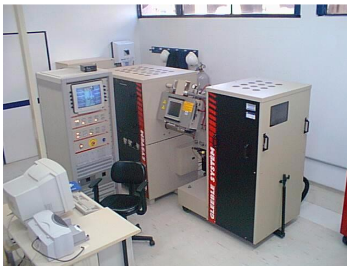
Figura 4 Simulador Termomecânico Gleeble 3500[8].
