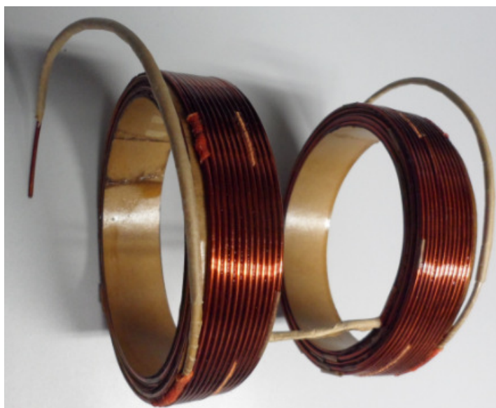
Figura 48 – Fotografia das bobinas ligadas em série.
