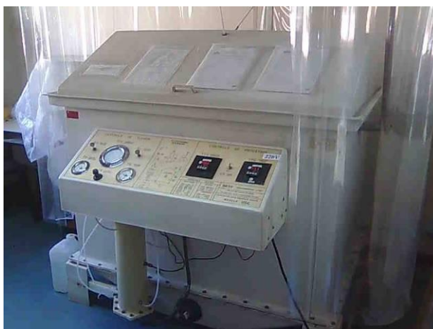
Figura 10 – Câmara de ensaio de corrosão por exposição a névoa salina.
