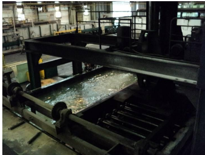
Figura 8 – Tanque de água utilizado para a realização do tratamento térmico de solubilização para as amostras utilizadas neste trabalho.
