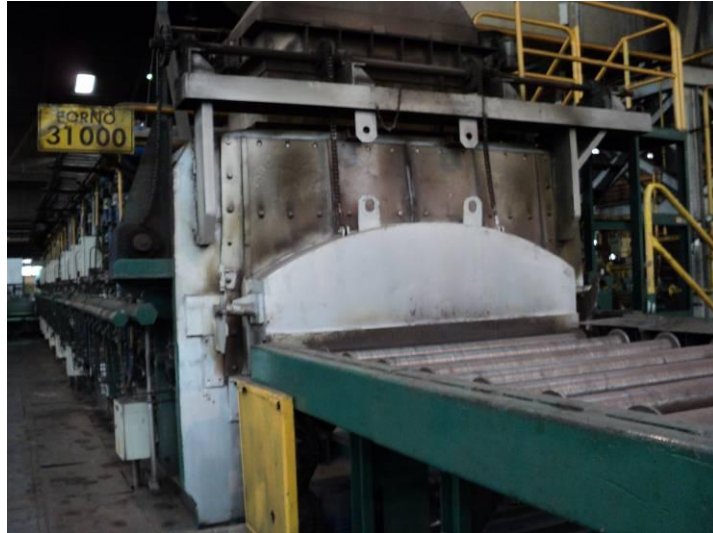
Figura 7 – Forno utilizado para a realização do tratamento térmico de solubilização para as amostras utilizadas neste trabalho.
