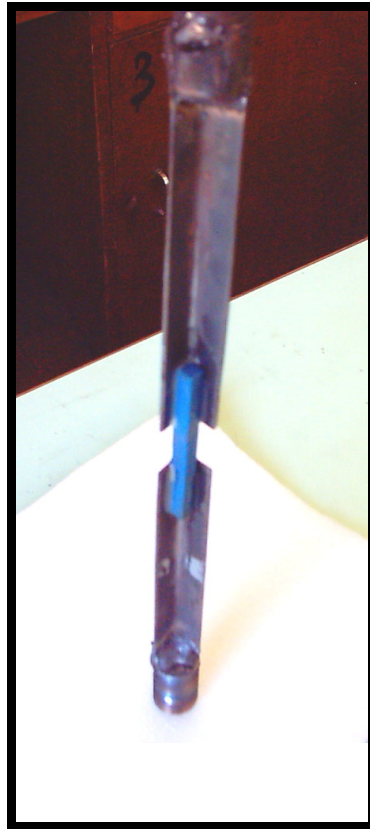
Figura 6.4: Vista do Amortecedor Por Esforços Axiais (AXL)
