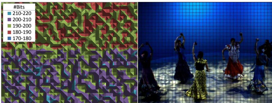
Figura 5.4 – Distribuição de *bitrate* para camada de BU (Flamenco2, QP=34).
