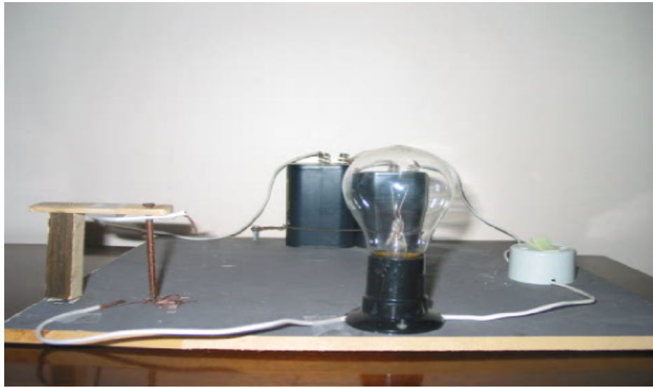
Figura 2: Foto do experimento: guindaste eletromagnético, construído pelos alunos do 3º ano do Colégio Estadual Piratini, no ano de 2003.
