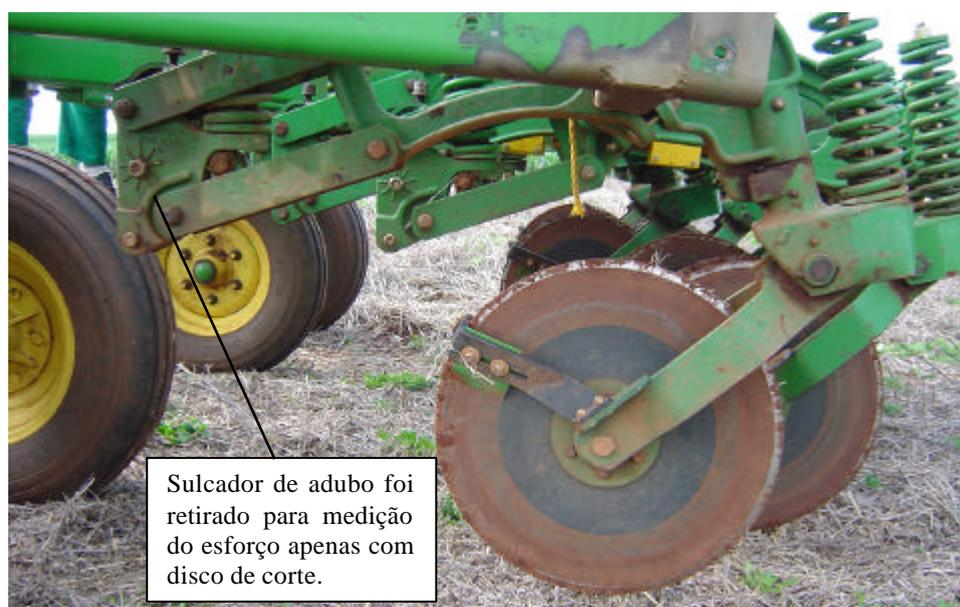
Figura 5.18 – Sete discos de corte de palha em avaliação do esforço de tração.
