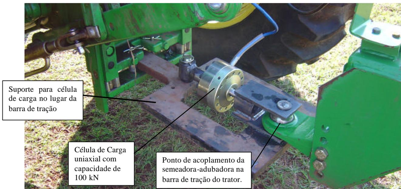
Figura 5.16 – Acoplamento de uma célula de carga uniaxial na posição da barra de tração do trator.
