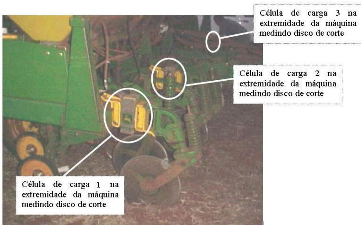
Figura 5.13 – Posicionamento das células de carga octogonais para avaliação dos esforços em 3 discos de corte.
