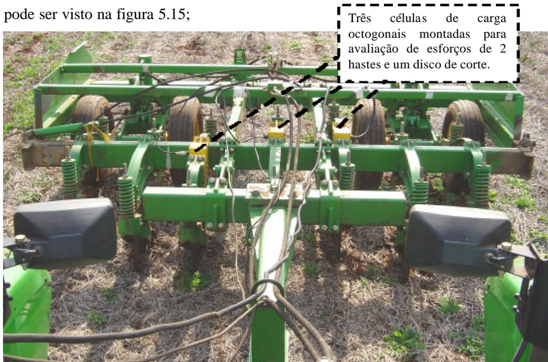
Figura 5.15 – Chassi de semeadora-adubadora adaptado para testes.
