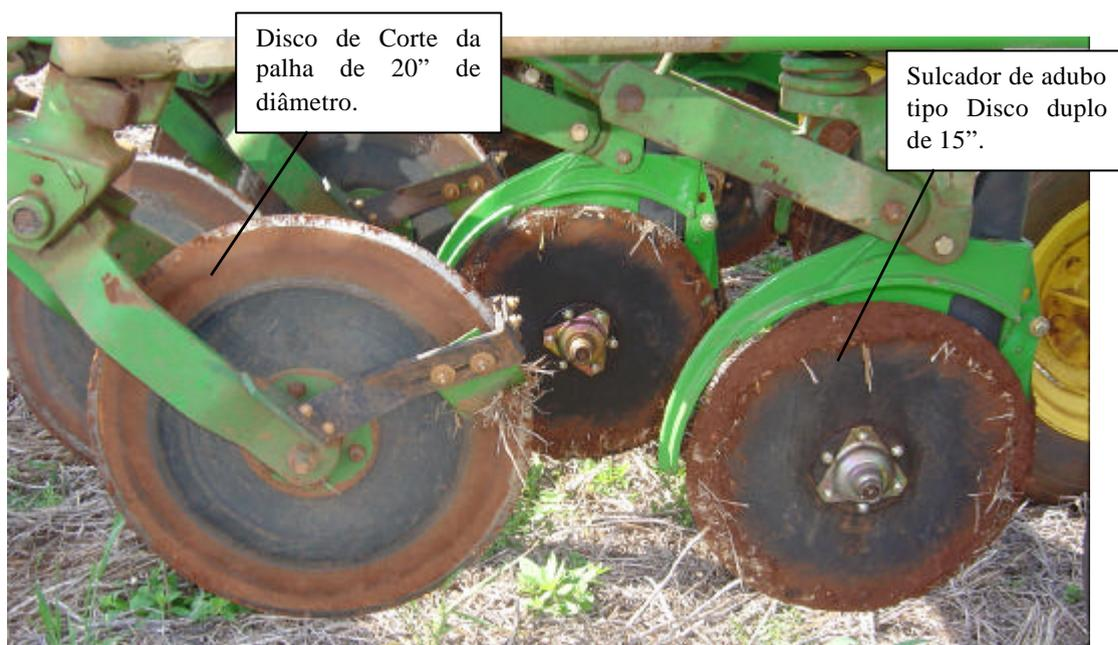
Figura 5.17 – Linha composta por disco de corte de palha e sulcador de adubo tipo disco duplo.
