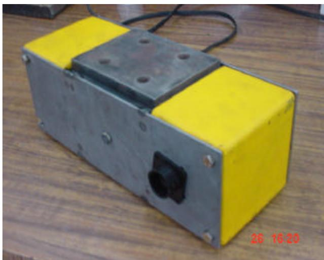
Figura 4.6 - Célula de Carga com proteção montada
