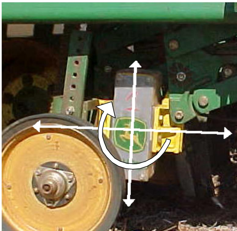
Figura 5.8 – Célula de carga montada na orientação Vertical
