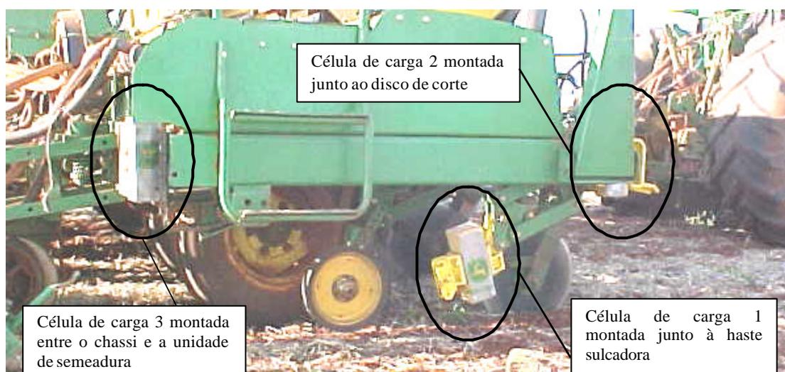
Figura 5.5 – Disposição das três células de carga para avaliação de três distintas funções da semeadora-adubadora.
