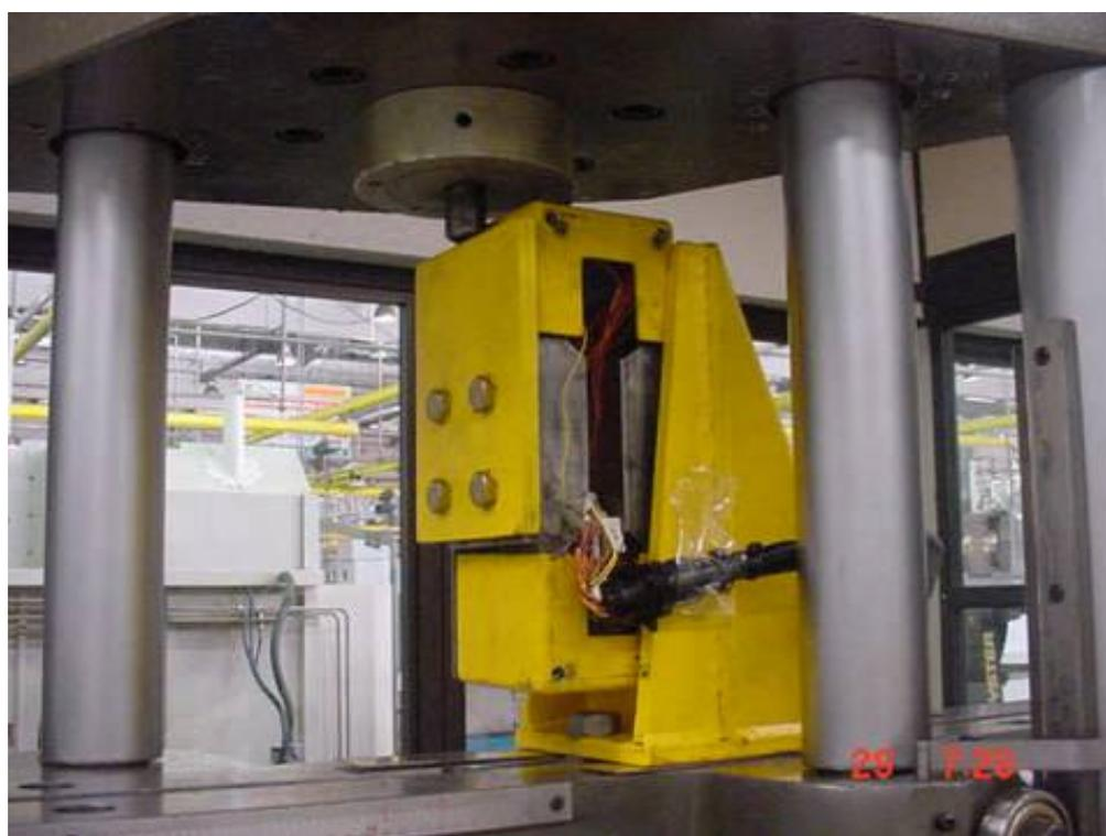
Figura 4.9 - Configuração de montagem em máquina universal de ensaio para calibração do eixo vertical da célula de carga.
