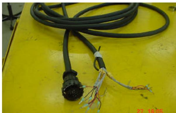
Figura 4.7 – Cabo especial, construído para ligação das células de carga octogonais.
