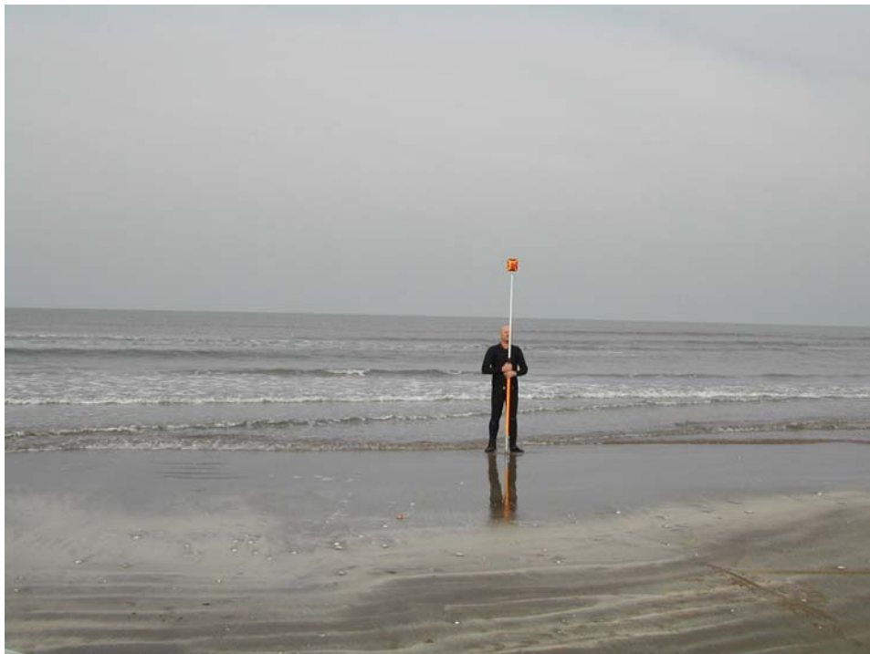
Figura 17 – Levantamento de perfil praiial com estação Nikon DTM-330.
