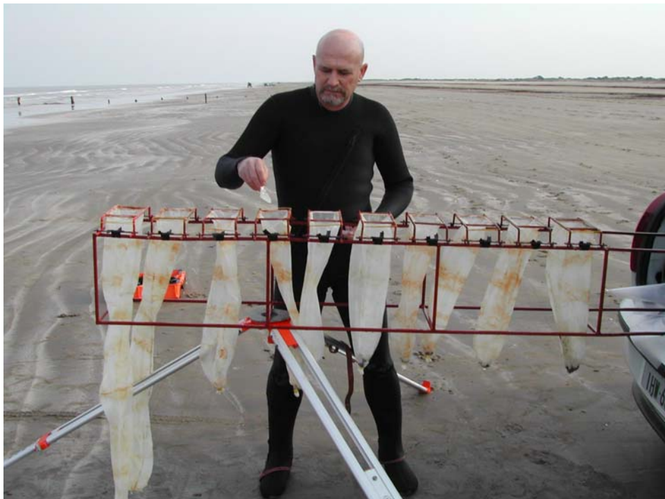
Figura 11 – Montagem, preparação e etiquetagem do conjunto de ‘traps’.
