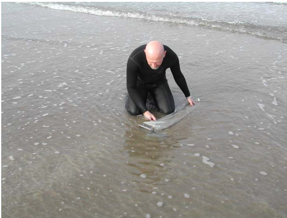
Figura 15 – Coleta de sedimento no espraiamento
