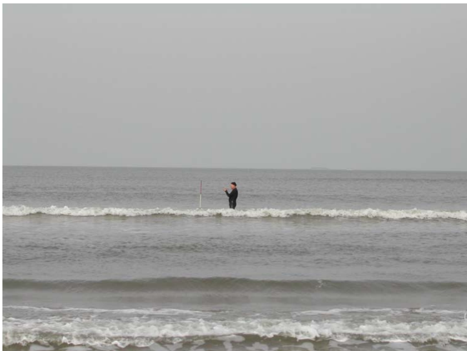
Figura 22 – Determinação do ângulo de incidência das ondas na arrebentação.
