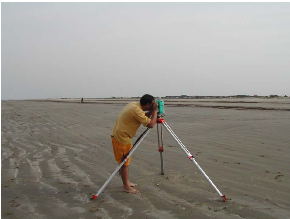
Figura 16 – Levantamento de perfil com estação total Nikon DTM-330.
