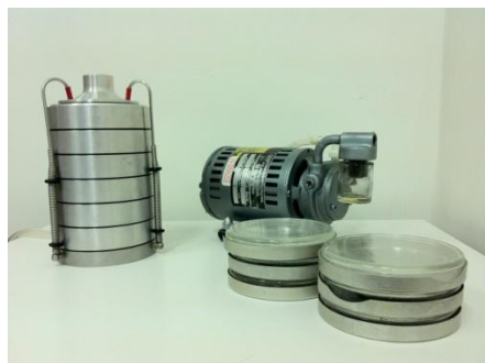
Figura 1. Coletor de Andersen ® . Equipamento que utiliza o princípio de impactação direto no ágar de partículas biologicamente viáveis suspensas no ar.
