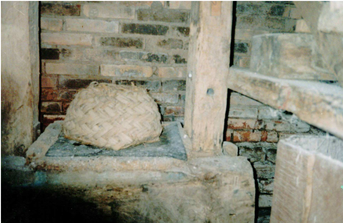
FIGURA 5 – Tipitim na prensa. Eram empilhadas uma média de 06 destes, com a massa da mandioca crua para ser pressionado.
