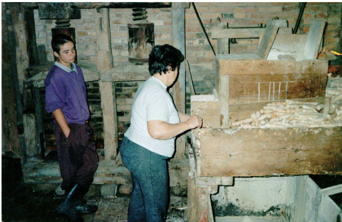
FIGURA 3 – À frente o cevador, que irá transformar a mandioca em pasta. Ao fundo duas prensas manuais. Existem outros modelos, mas estas eram as mais comuns.
