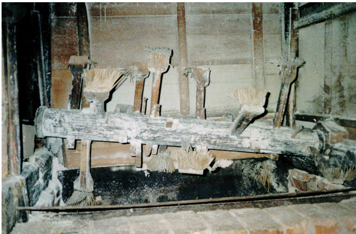
FIGURA 6 – O forno para torrar a farinha. Possuíam pás em forma de vassouras, que deveriam ser permanentemente controladas, mantendo sempre em sentido circular, para não deixar queimar.
