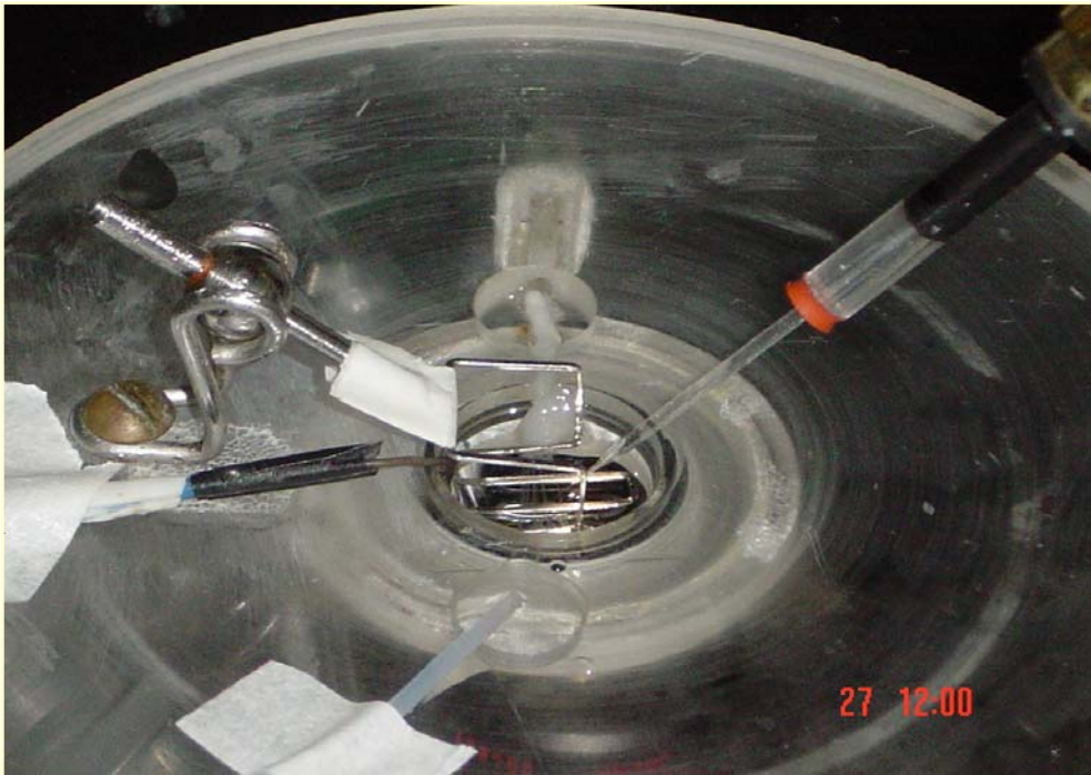
Fig 3.3: Câmara de Perfusão , onde podem ser observados , à esquerda eletrodo de referência (Ag/AgCL) e à direita o eletrodo de registro, conectado ao “holder”, ambos imersos na preparação.
