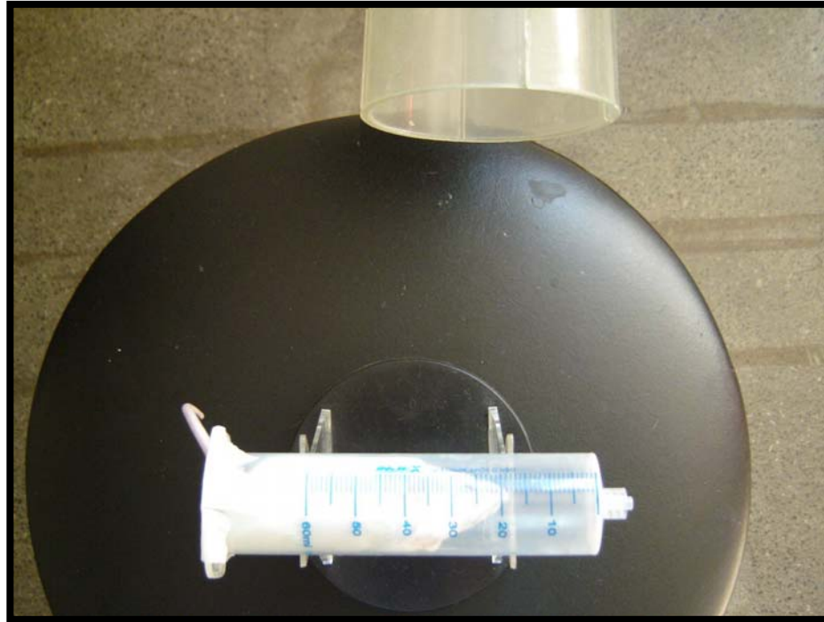
Figura 1 – Camundongo dentro da seringa, posicionado a uma distância foco-animal de 20 cm.
