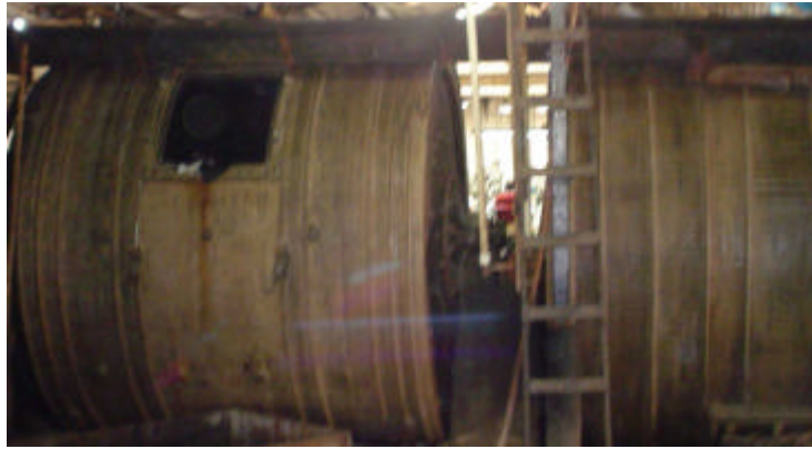
Figura 3.7: Fulão de remolho e depilação/ caleiro
