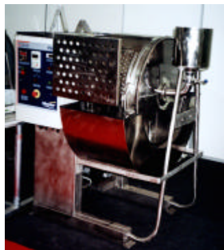
Figura 3.3: Fulão do processo piloto
