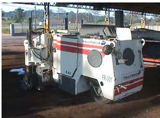
Figura 18 - Fresadora W350 – Wirtgen. Fonte: (foto obtida no local, outubro/2003)
