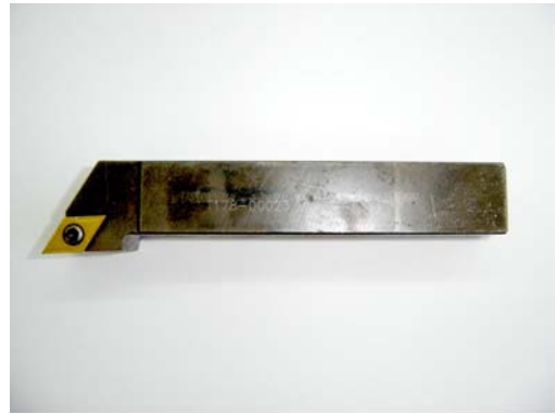
Figura 18: Porta-ferramentas com pastilha
