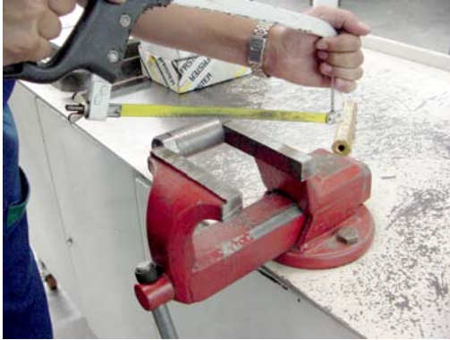
Figura 33: Corte de peças manual para verificar dimensões internas (antes das melhorias)
