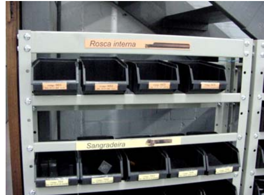
Figura 24: Caixas para porta ferramentas do CNC agrupadas por famílias de função e com etiquetas coloridas.
