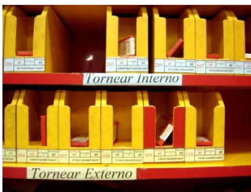
Figura 27: Disposição das caixas do estoque das pastilhas (depois das melhorias)
