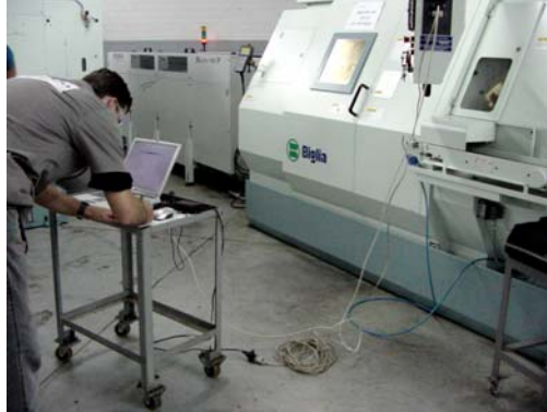
Figura 32: Conexão do notebook com o torno (depois das melhorias)
