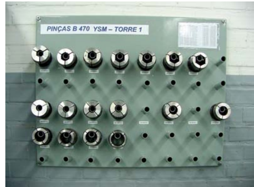
Figura 10: Quadro de pinças com identificação (depois da melhoria)
