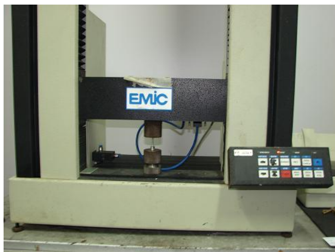
Figura 18 - Máquina universal de tração utilizada no estudo.
