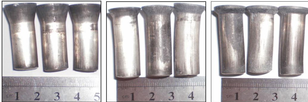
Figura 58 - Peças extrudadas da liga de magnésio AZ61 recristalizada em matrizes com ângulos de cone de 30°, 60°, 90°, respectivamente da esquerda para a direita [55].
