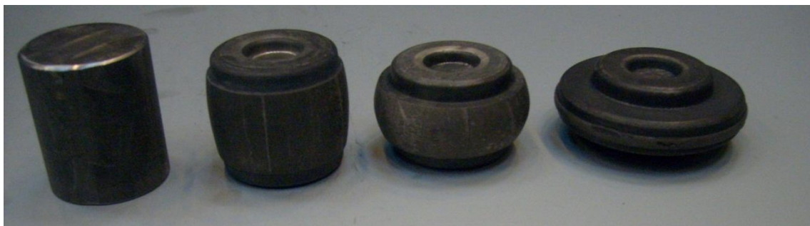
Figura 80 – Etapas de conformação da peça de trabalho. Da esquerda para a direita: billet , 1ª etapa, 2ª etapa e 3ª etapa.
