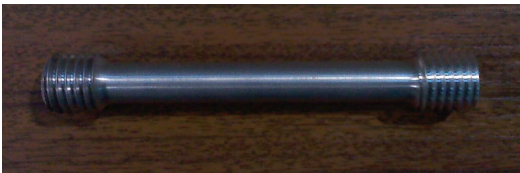
Figura 23 – Corpo-de-prova para ensaio de tração.
