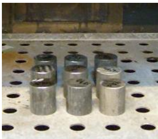
Figura 37 – Billets de liga de magnésio AZ61 para forjamento de polia.
