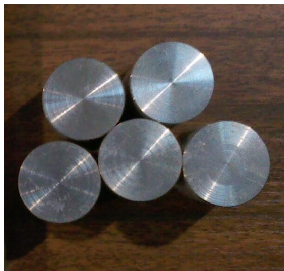
Figura 22 – Corpos-de-prova para ensaio de resistência à compressão da liga Mg AZ61 recristalizada.
