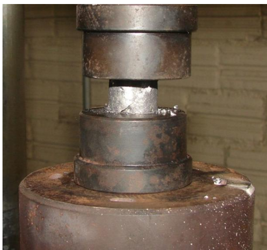
Figura 17 – Aspecto da fratura em corpo-de-prova ensaiado por compressão.
