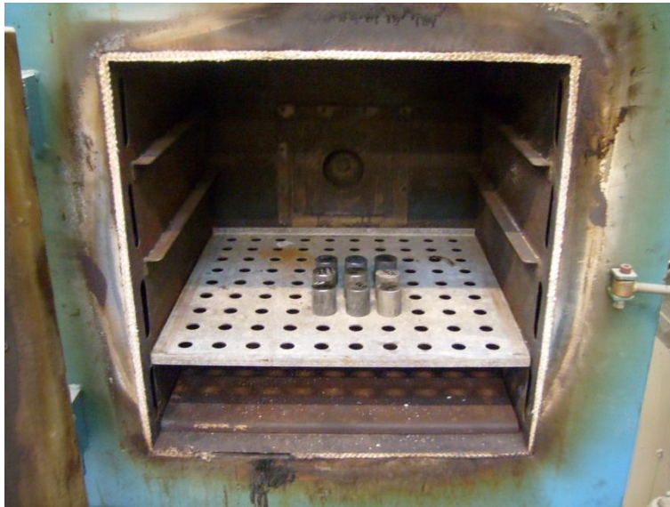
Figura 44 – Forno de aquecimento com circulador de ar interno.
