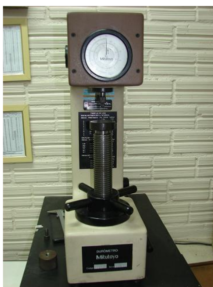
Figura 16 - Durômetro marca Mitutoyo, utilizado no estudo.
