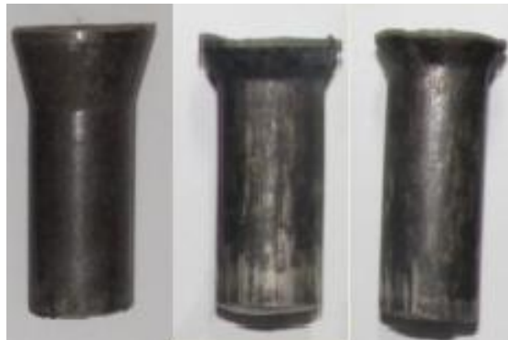
Figura 53 – Peças extrudadas com a liga AZ61 fundida.
