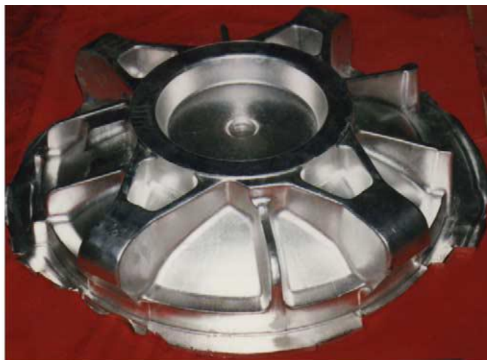
Figura 14 – Peça de magnésio forjada em matriz de precisão [49].
