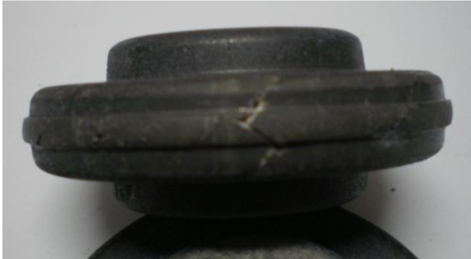
Figura 79 – Peça obtida por etapa única a 250 °C, apresentando trincas.
