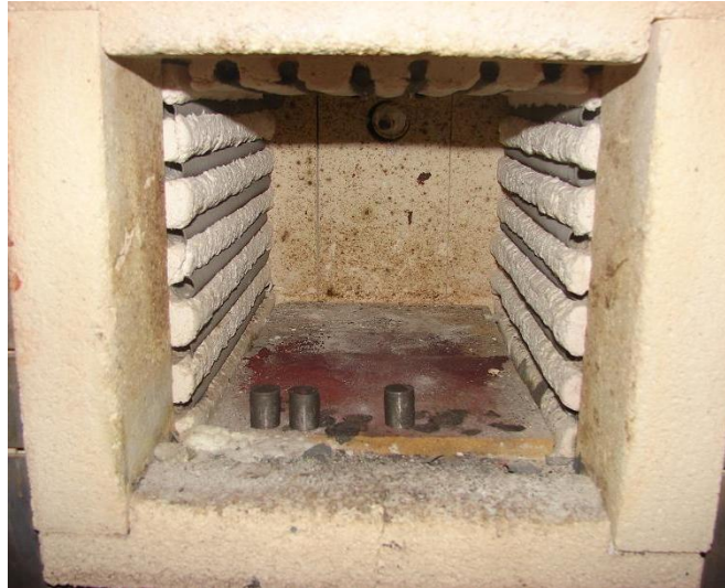
Figura 30 – Billets de liga de magnésio AZ61 lubrificados.
