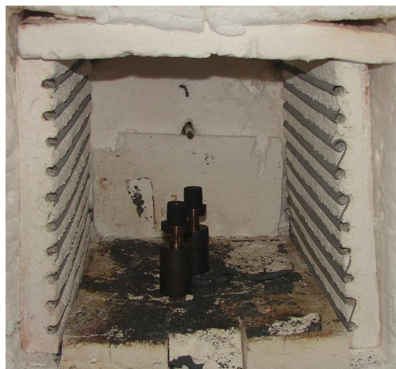
Figura 31 – Aquecimento simultâneo do ferramental e da matéria-prima.
