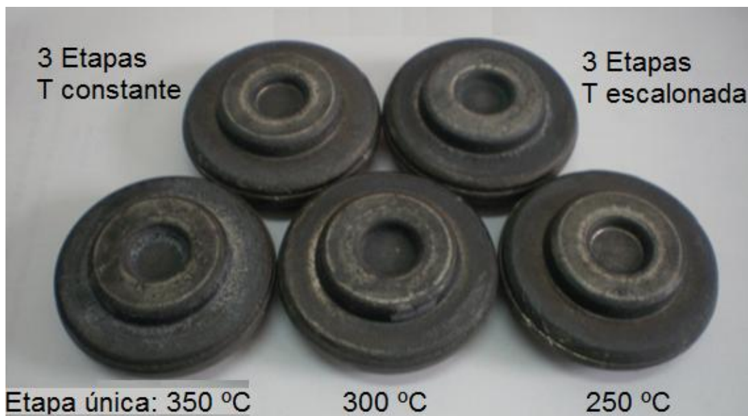
Figura 78 – Peças forjadas em diferentes temperaturas e etapas de conformação.
