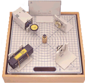
Figura 13: Interferômetro (imagem cedida pela empresa de materiais de laboratório Cidepe - Canoas - RS)
