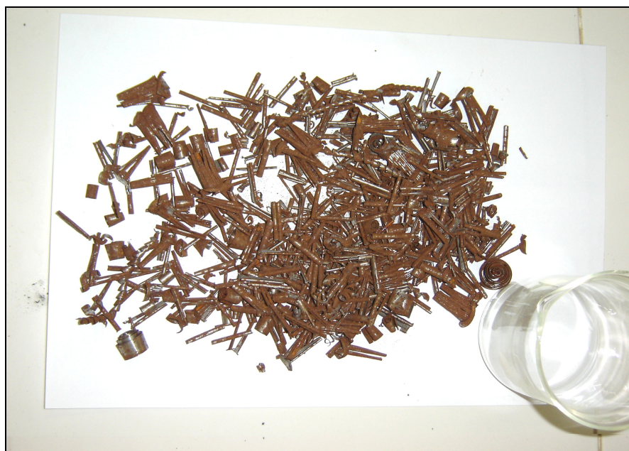
Figura 11 - Cavaco de usinagem utilizado na 2ª etapa junto a um Becker de 200 mL.
