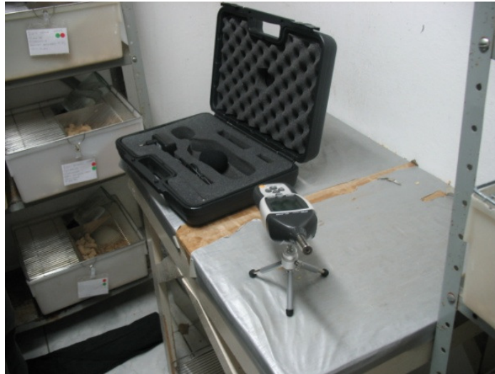
Figura 7- Utilização do sonômetro para medição do ruído de fundo
